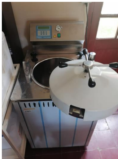
Figura 15: Esterilización por autoclave: 121^{\circ}\text{C} \times 1.5\text{atm} \times 20\text{minutos} .
