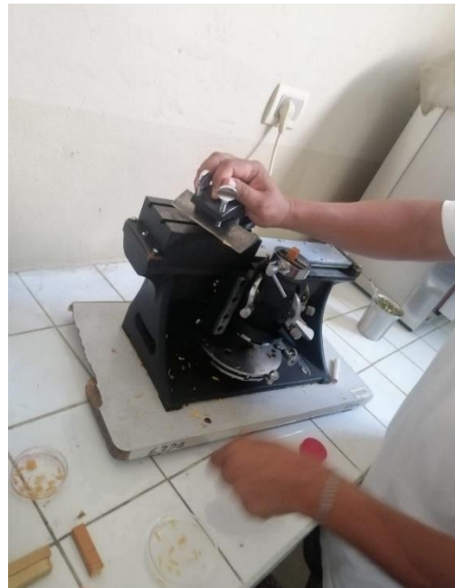
Obtención de los chips en el microtomo
