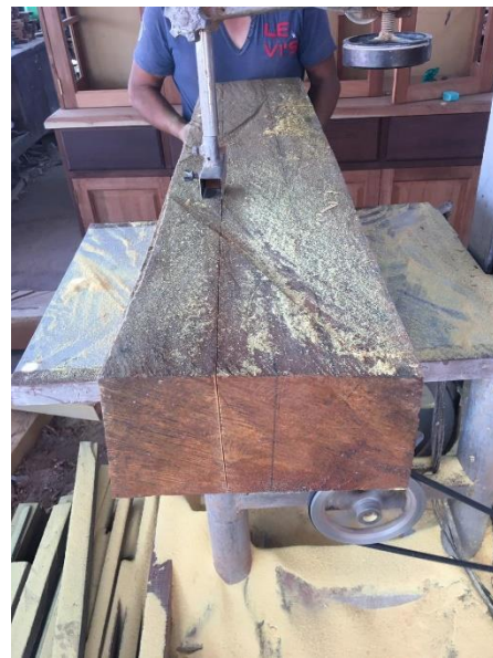
Aserrío para la obtención de las probetas
