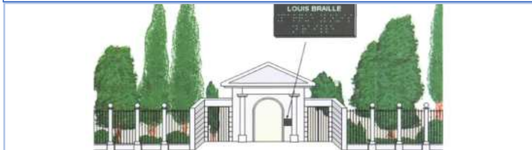
Figura 51: Señalización vertical en braille
