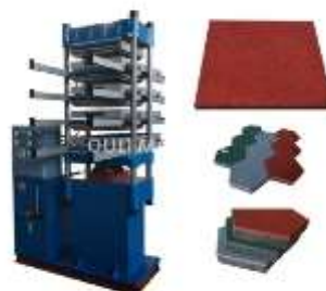
FIGURA 20: MAQUINARIA DE FABRICACIÓN DE CAUCHO BLOQUES DE SUELO
