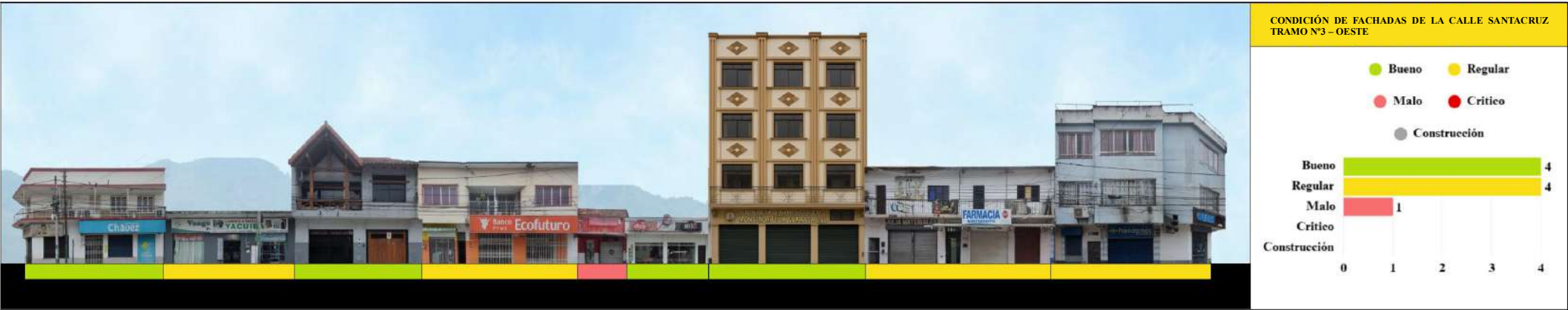
Figura N° 83 Condición de fachada de la calle santa cruz - oeste
