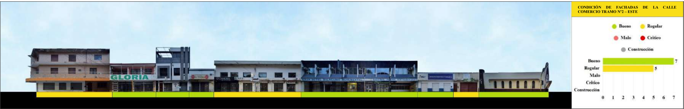
Figura N° 81 Condición de fachada de la calle comercio- este
