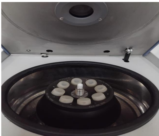
Figura II-11. Purificación (Centrifugación Primaria)
