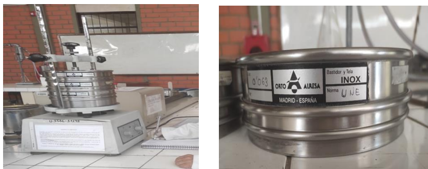
Figura. 14: Tamizador utilizado para la elaboración de harina de hoja de penca de tuna
