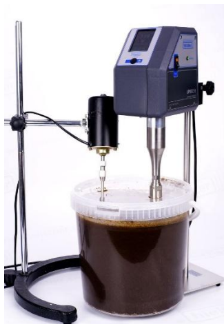
Fig. I-5 Extracción solido-liquido asistida por Ultrasonido
