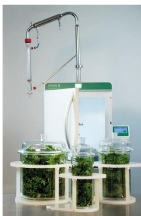
Fig. I-4 Extracción solido-liquido asistida por Microondas
