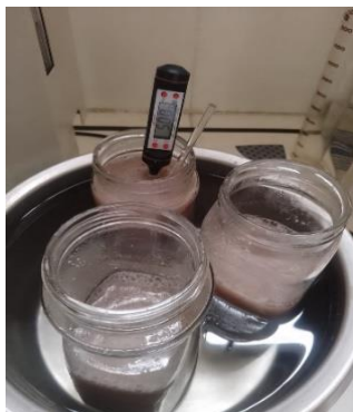
Figura II - 2: Extracción sólido - líquido (maca - agua)
