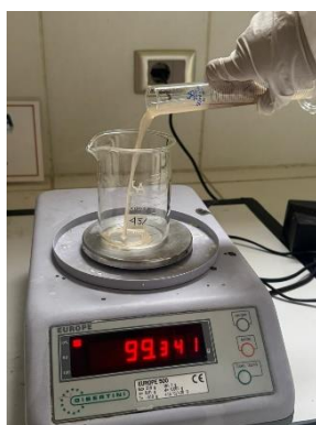
Alícuota usada para el secado y pesado del vaso precipitado más el extracto para el control del peso.
