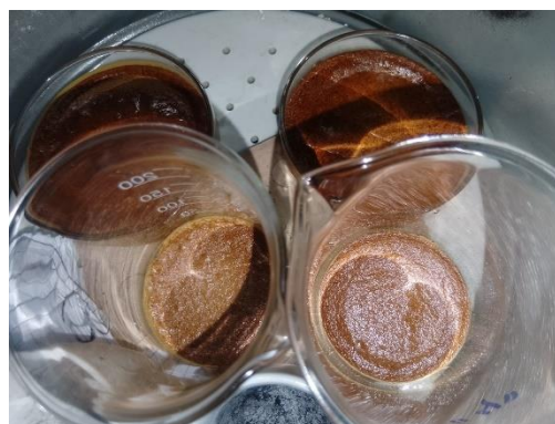
Alícuota usada para el secado y pesado del vaso precipitado más el extracto para el control del peso.
