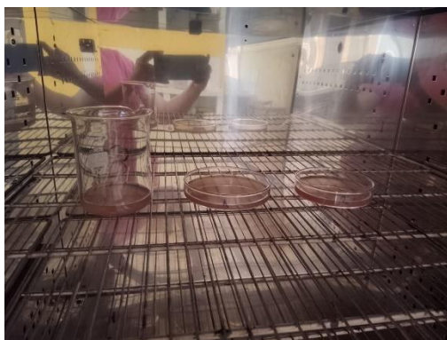
Alícuota usada para el secado y pesado del vaso precipitado más el extracto para el control del peso.
