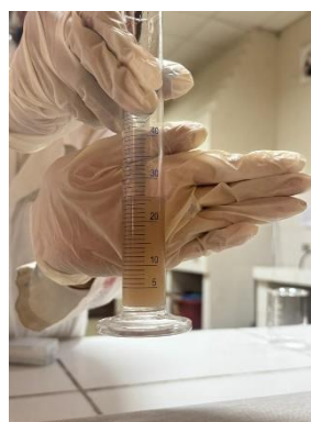
Alícuota usada para el secado y pesado del vaso precipitado más el extracto para el control del peso.
