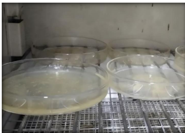
Fotografía 2-8 Secado de la pectina en la incubadora
