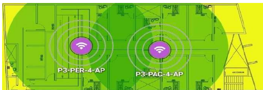
Figura 161. Nivel de señal bajo Tercer Piso
