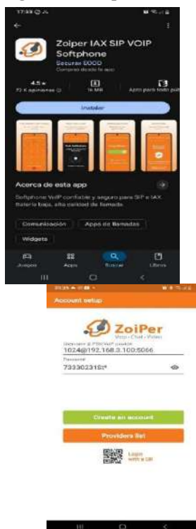
Figura 264. Dentro de la Aplicación Necesitamos Colocar la Extensión Creada Seguido de @ y la Dirección del Servidor de Telefonía IP agregando: el puerto que se está utilizando y la Contraseña Creada en el Servidor
