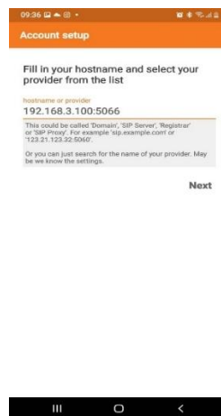
Figura 390. En Hostname Dejamos la IP del Servidor de Telefonía IP
