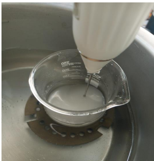
Figura 2-13: Homogenización de mezcla
