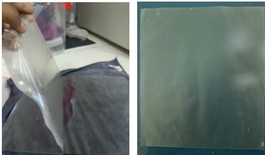
Figura 2-16: Desmoldado y almacenado de lámina de plástico biodegradable
