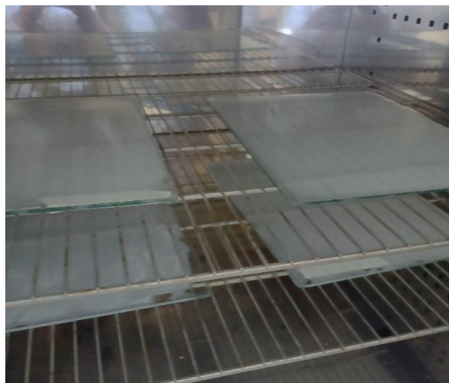
Figura 2-15: Secado de láminas de Plástico biodegradable
