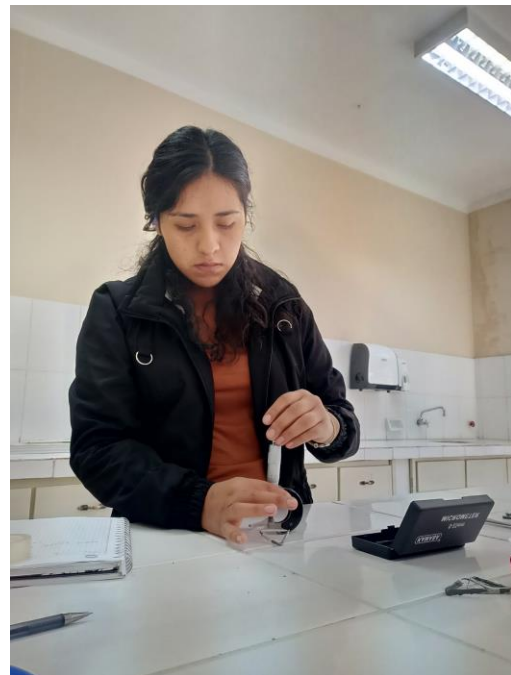
Medidas de espesor de probetas de bioplástico
