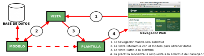
Figura 10. Funcionamiento del MTV de Django
