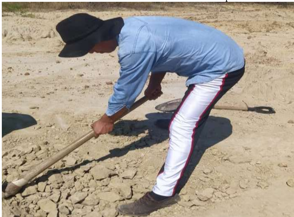
Gráfico N° 4. Sacado de muestra de arcilla de alta plasticidad
