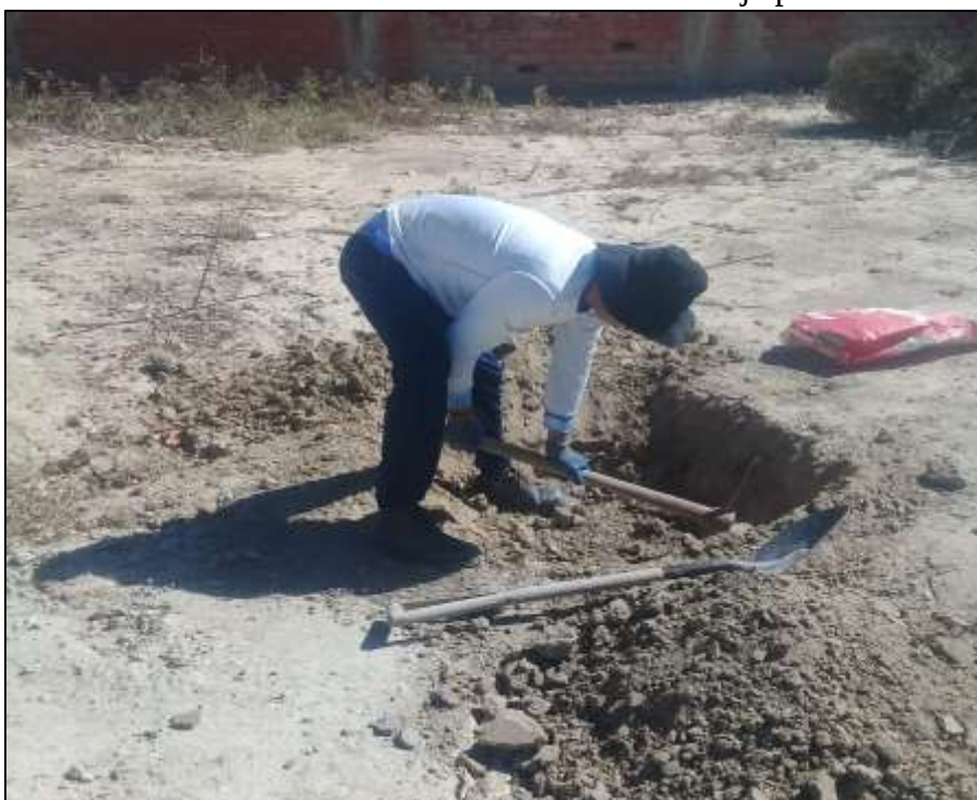
Gráfico N° 3. Sacado de muestra de arcilla de baja plasticidad
