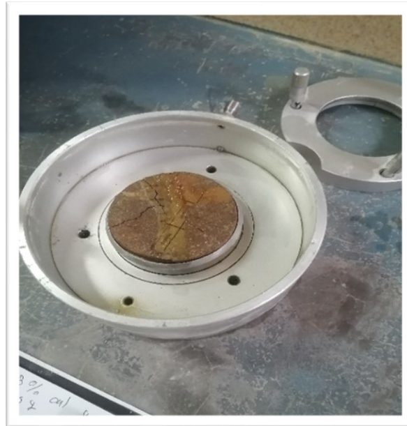
Figura 38. Anillo de edómetro con piedras porosas
