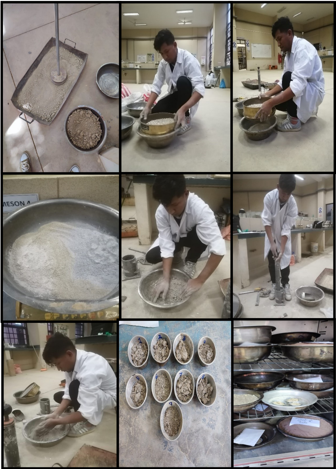
Memorias fotográficas N°3. Ensayo de compactación.
