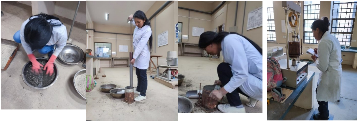
Figura 58. Ensayo del CBR incorporando ceniza de rastrojo de maíz
