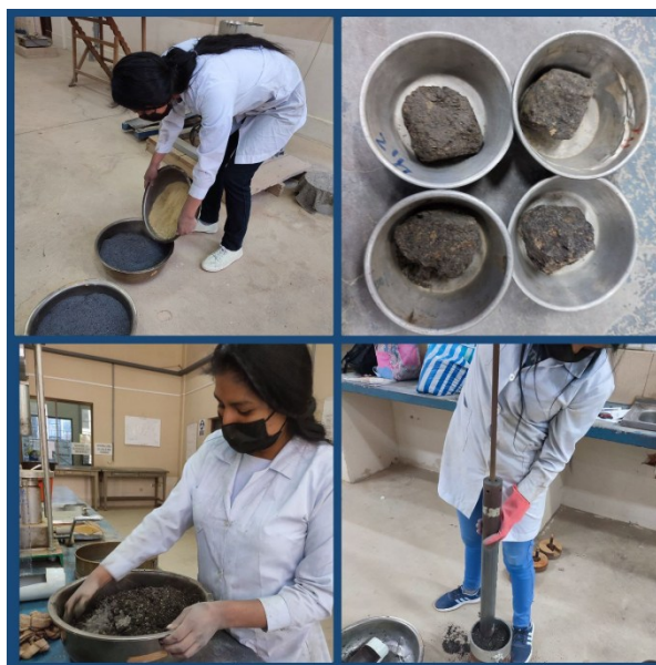
Figura 57. Ensayo de compactación incorporando ceniza de rastrojo de maíz
