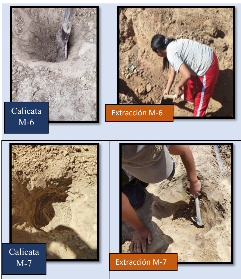
Figura 32. Calicatas y extracción del barrio Constructor
