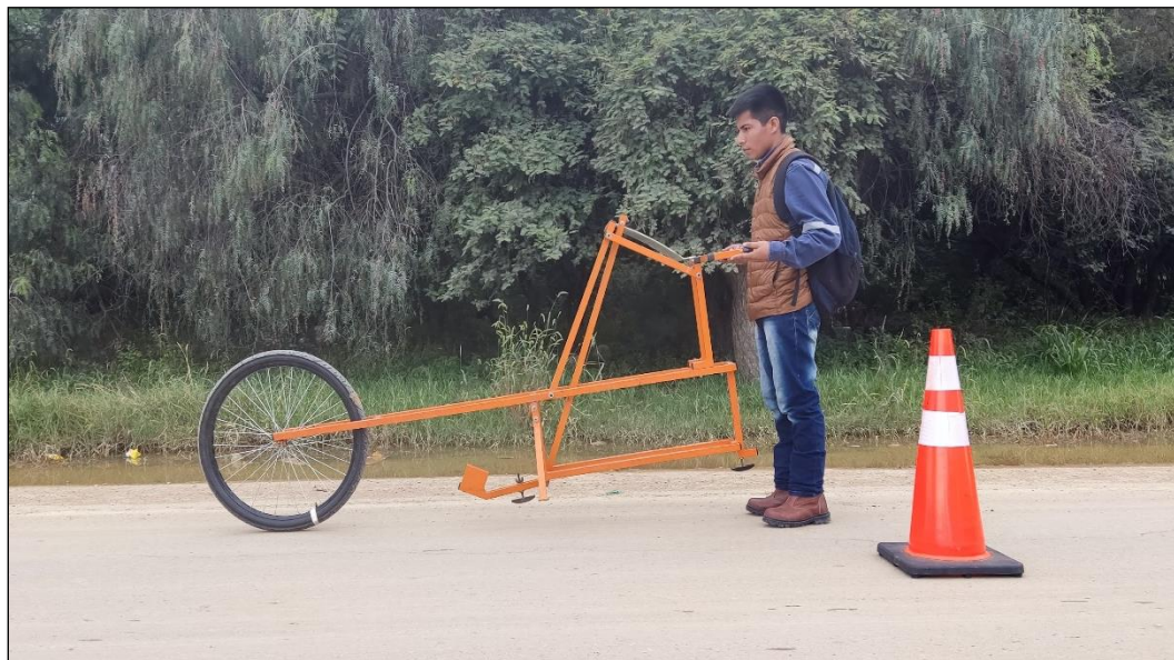
Figura N° 59.- Equipo para la medición de la rugosidad superficial con Merlín
