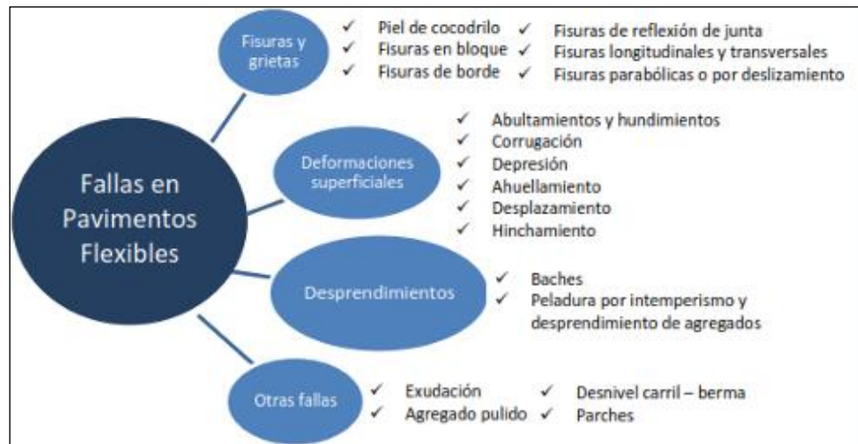
Figura N° 5.- Fallas en los pavimentos flexibles establecidos por PCI
