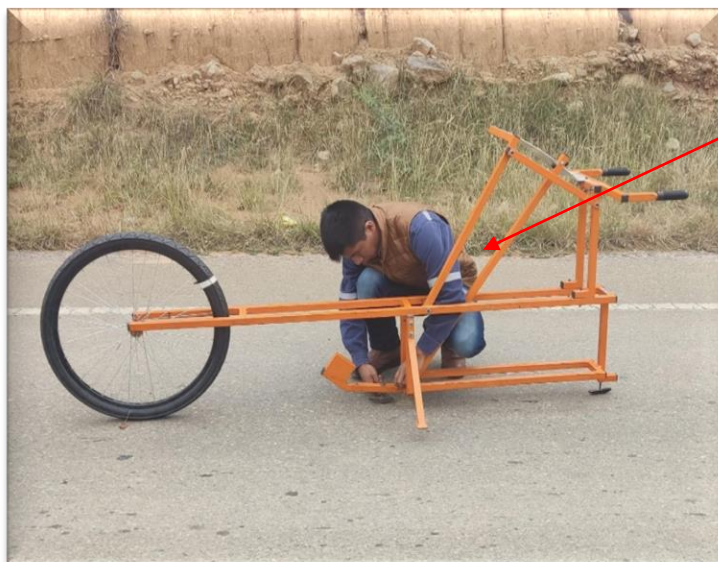
Figura N° 77.- Calibración del equipo de Merlín
