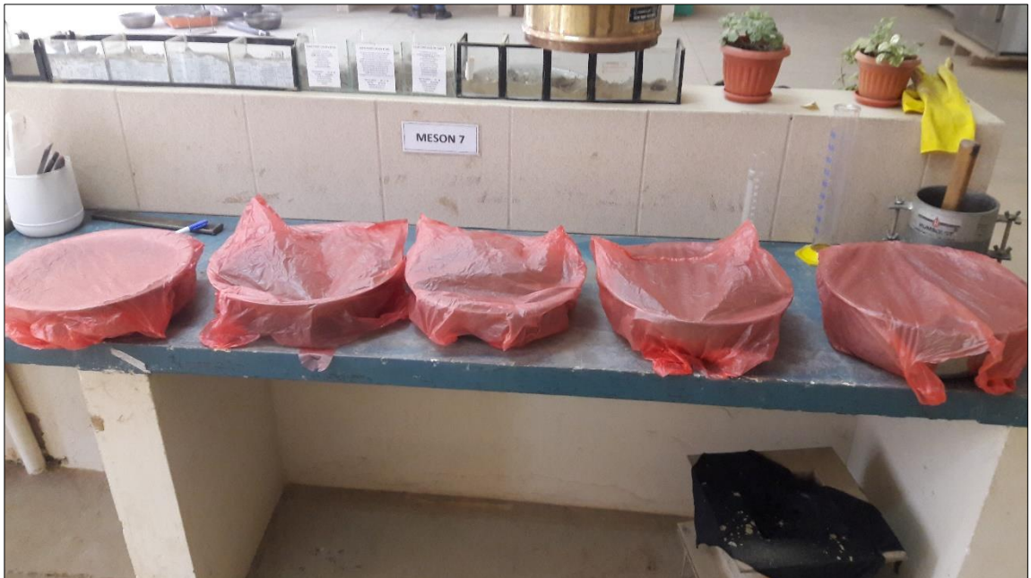
Definición de rangos de humedad: \pm por debajo y encima de la óptima
