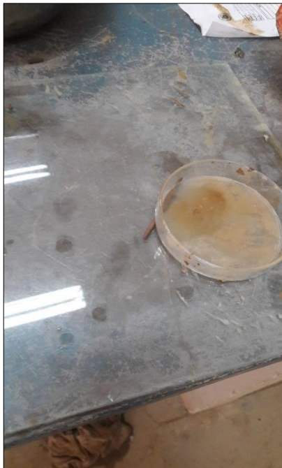
Vidrio liso sobre la superficie para transformar una pelotita de suelo húmedo a un pequeño rollito
