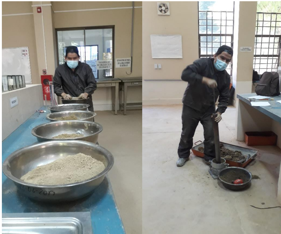
Proceso homogenización y compactación
