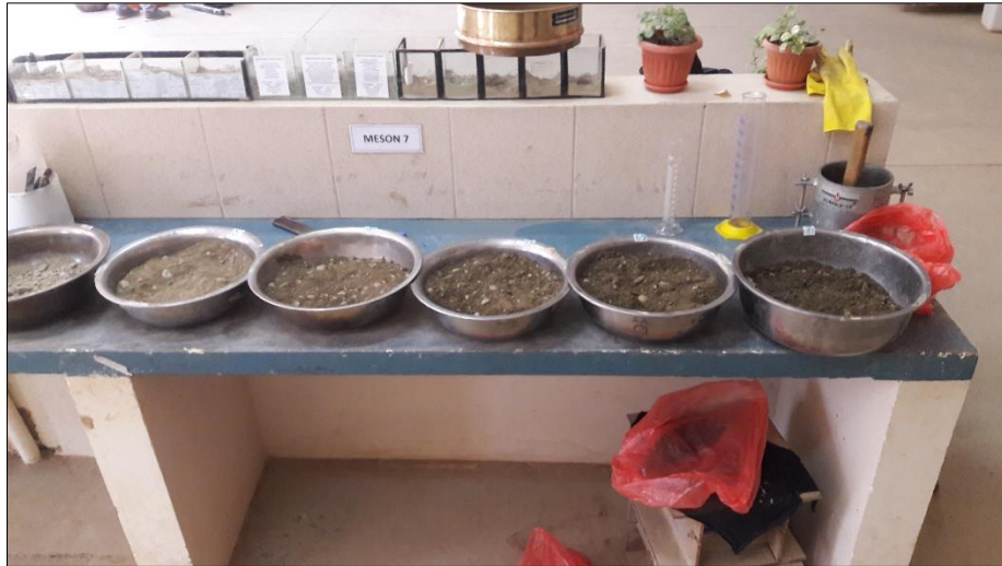
Variación de humedades manualmente
