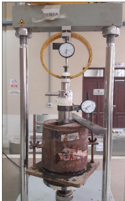
Prueba de penetración sobre cada muestra
