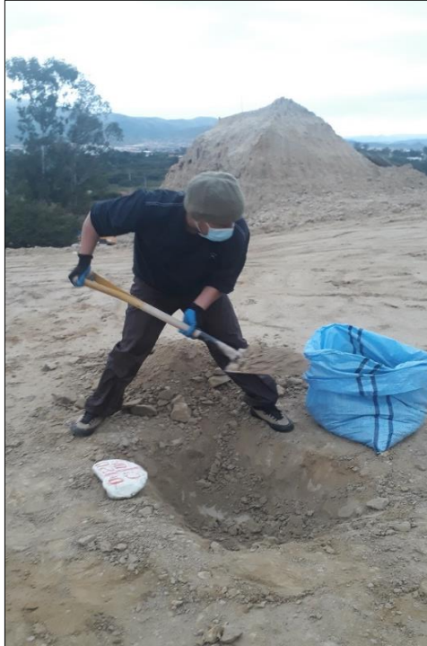
Toma de muestra de la sub rasante
