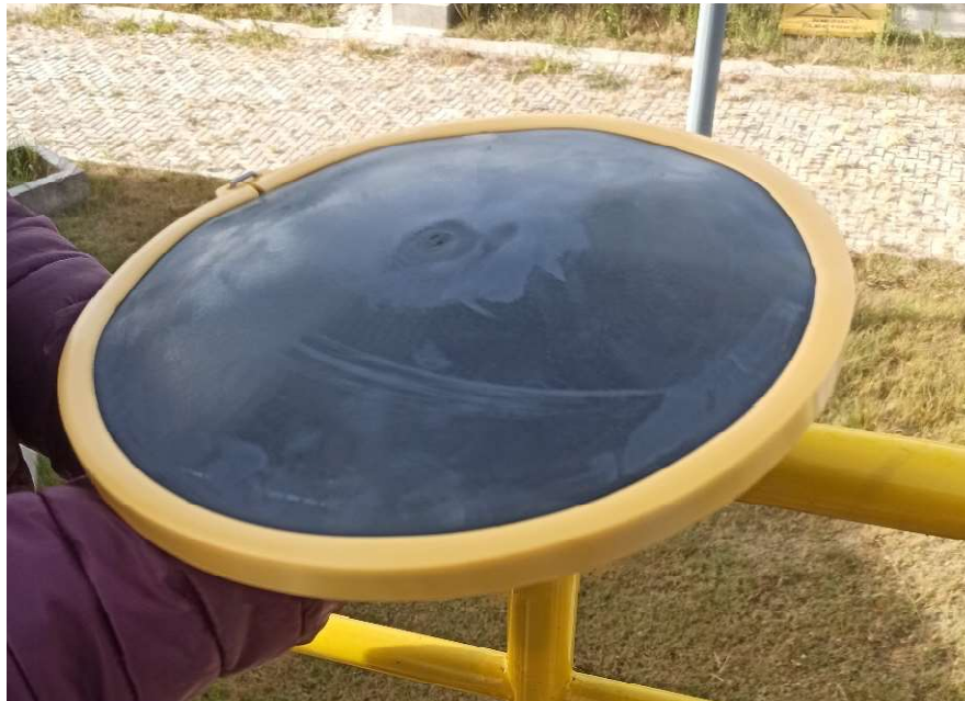
Figura 18. Difusor de burbuja fina del reactor de lodos activados.
