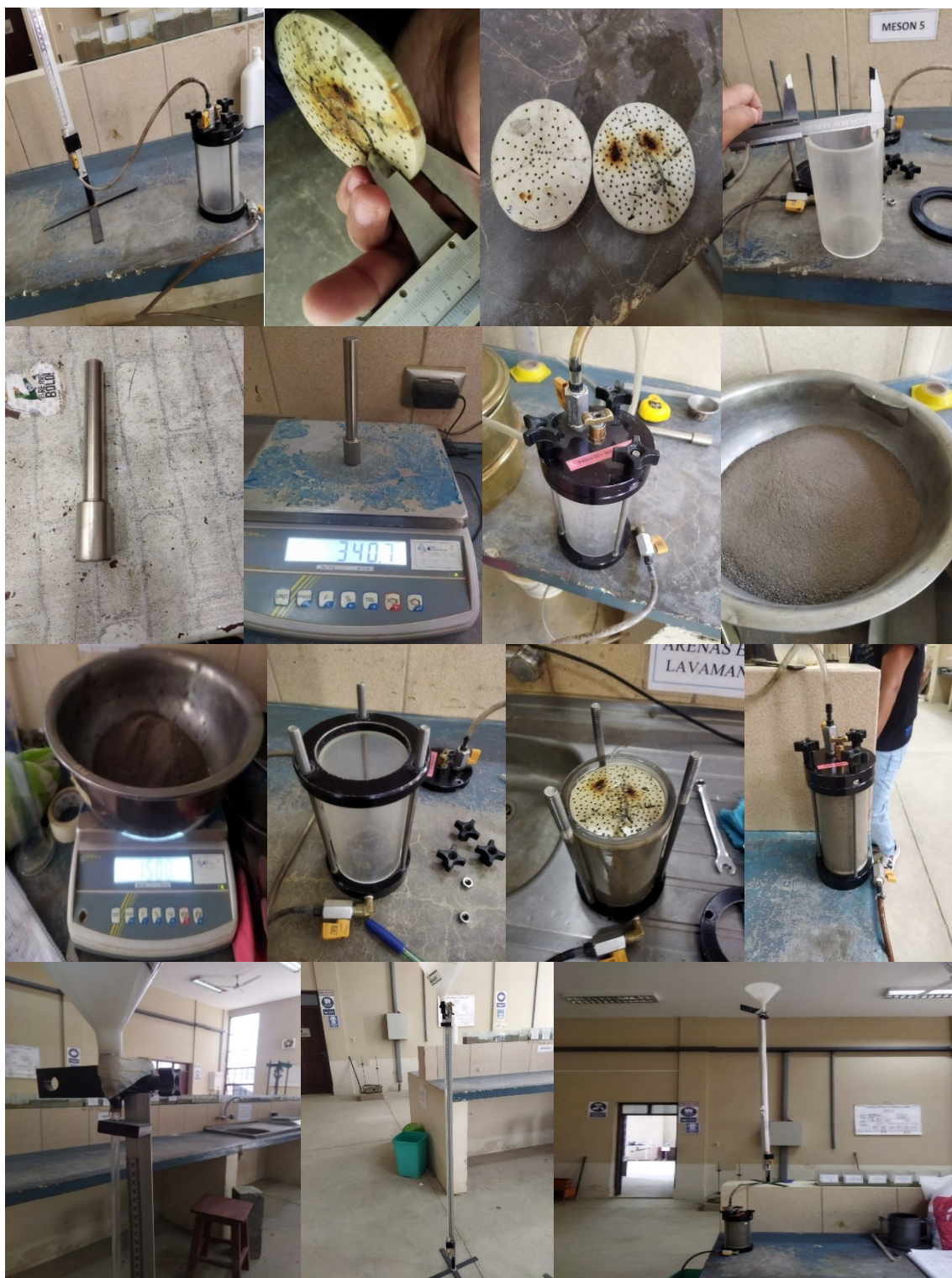
Figura 3. 15. Ensayo de permeabilidad
