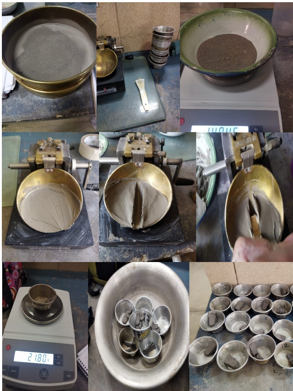
Figura 3. 12. Determinación del Límite Líquido
