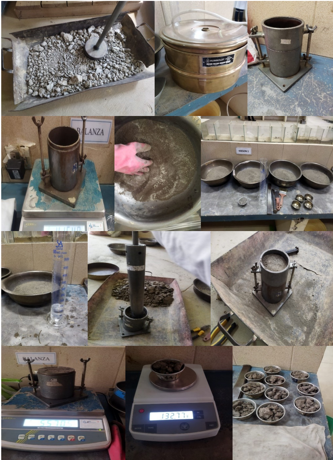
Figura 3. 14. Ensayo de compactación
