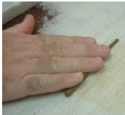
Figura 2. 11. Prueba de límite plástico
