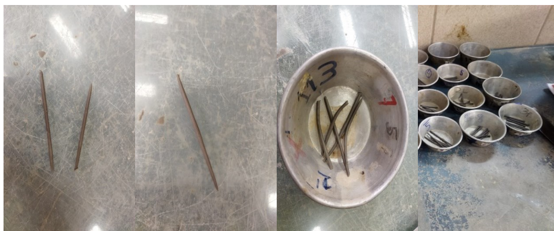
Figura 3. 13. Determinación del Límite plástico
