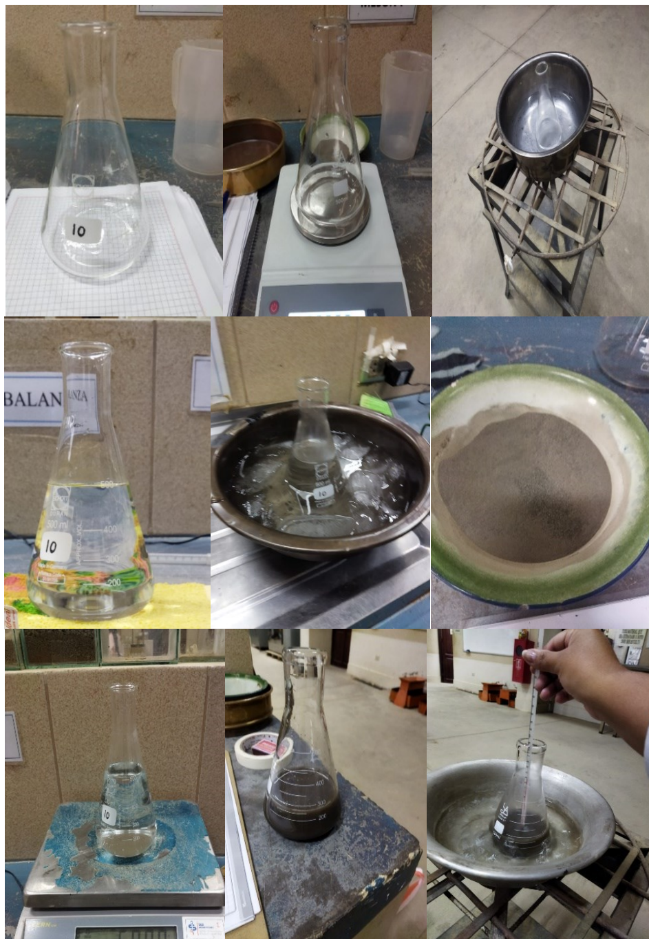
Figura 3. 10. Determinación del peso específico relativo de los sólidos
