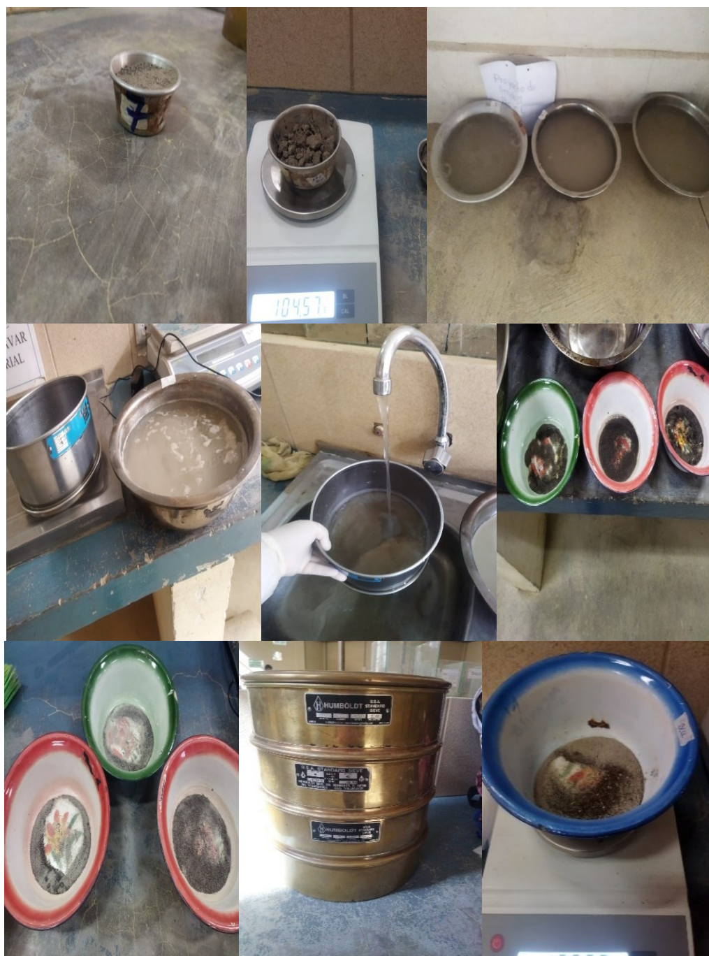
Figura 3. 9. Granulometría por tamizado (método del lavado)
