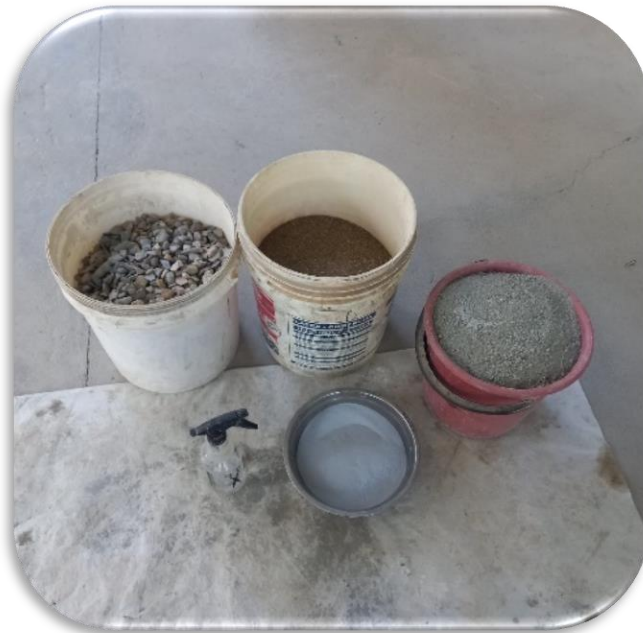
Figura 12. Materiales pesados para la mezcla
