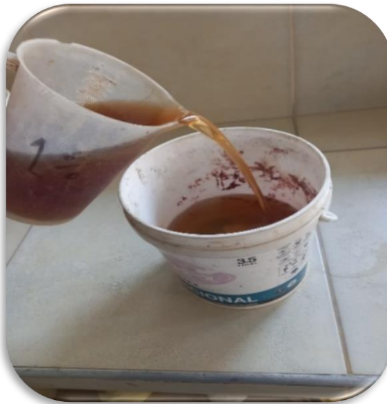
Figura 13. Mezcla inicial del aditivo superplastificante con la primera mitad del agua
