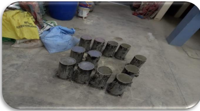
Figura 17. Probetas cilíndricas vaciadas con hormigón
