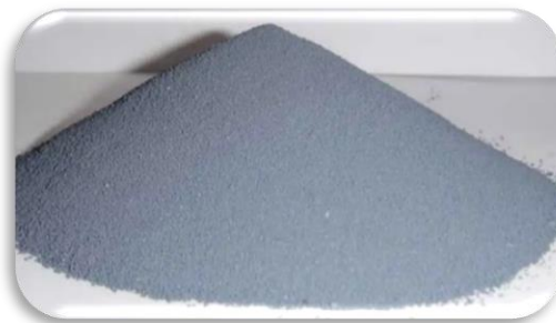
Figura 4. Microsílice o Humo de Sílice
