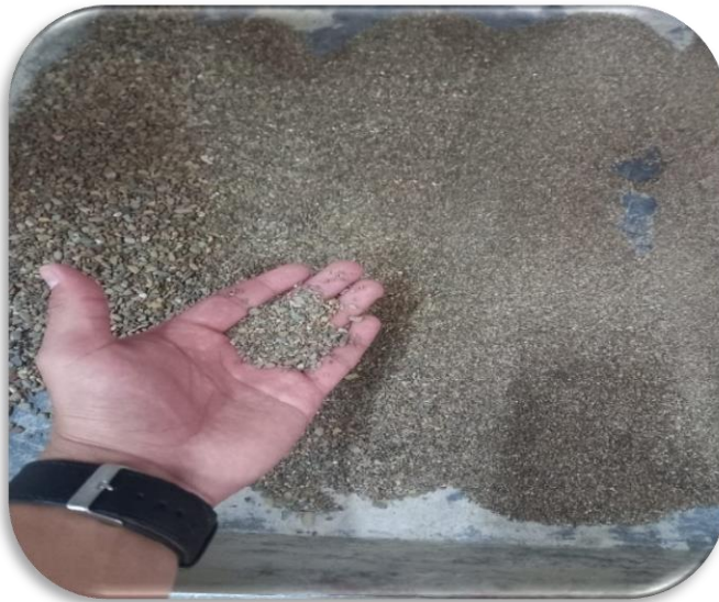
Figura 8. Partículas de agregado fino proveniente de Rio Tolomosa.
