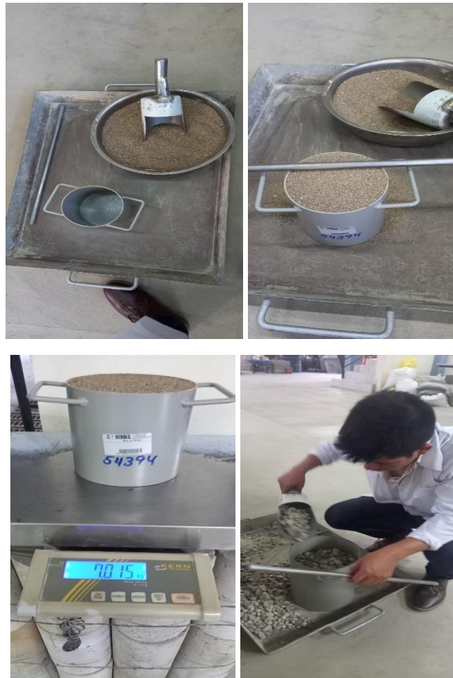
Ensayo para determinar peso unitario suelto y compactado agregado grueso y fino
