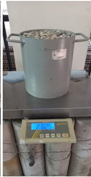
Ensayo para determinar Peso Específico y porcentaje de absorción
