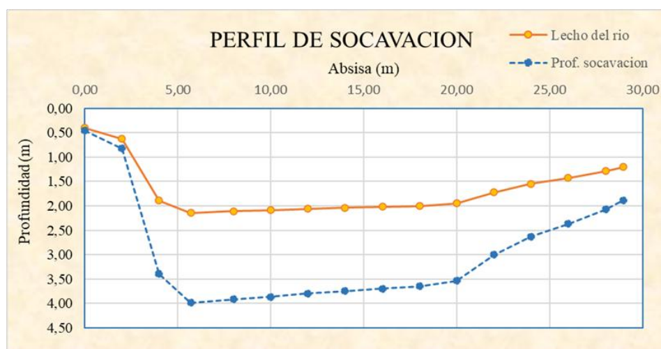
Figura 3.4 Perfil de socavación del lecho del río
