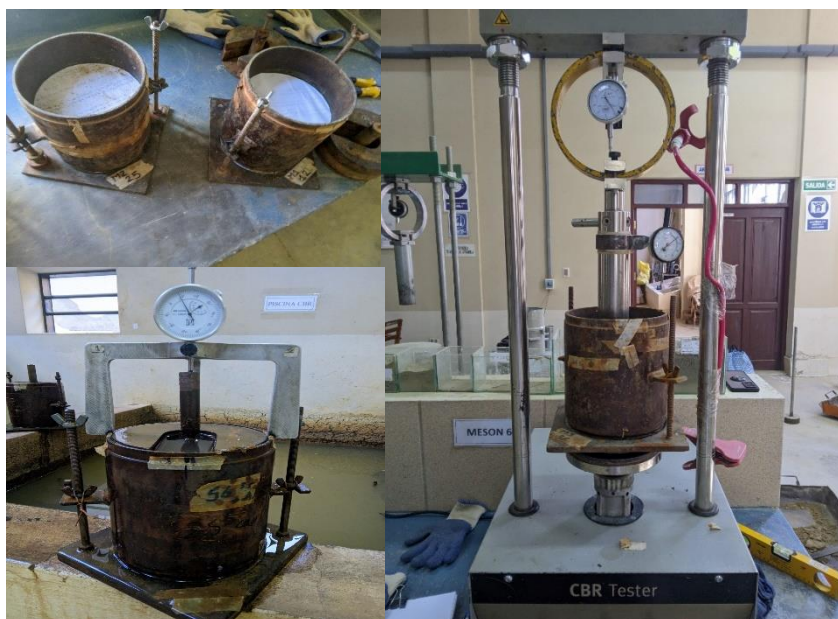
Figura 3.16 Proceso para realizar el ensayo de CBR
