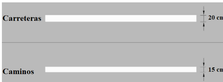
FIGURA 18: DIMENSIONES DE DEMARCACIÓN CONTINUA
