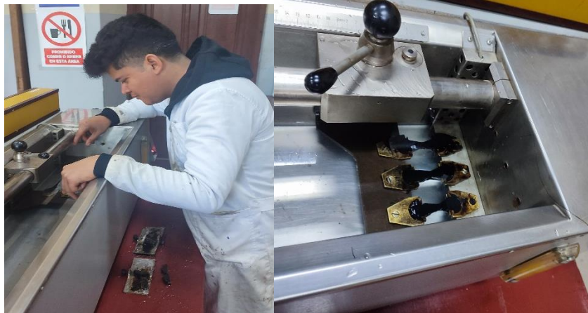
Figura 30. Medición de la ductilidad del cemento asfaltico
