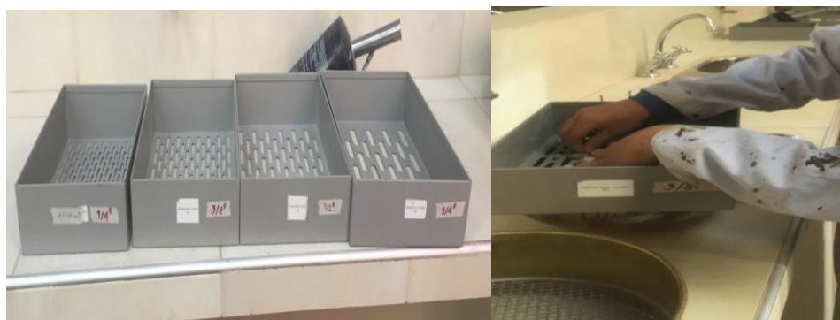
Figura 22. Evaluación del aplanamiento del material
