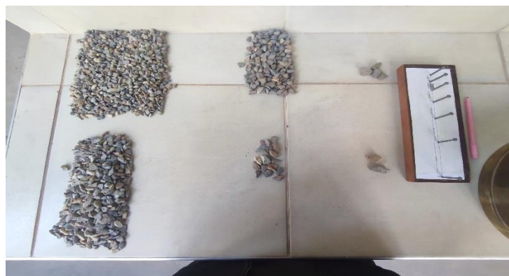
Figura 21. Evaluación del alargamiento del material
