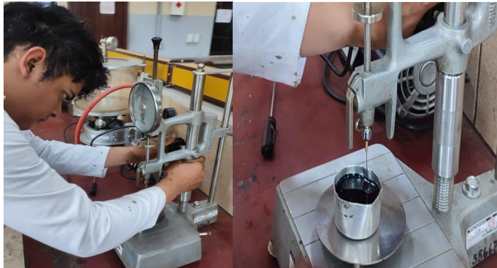
Figura 26. Medición con el equipo de penetración
