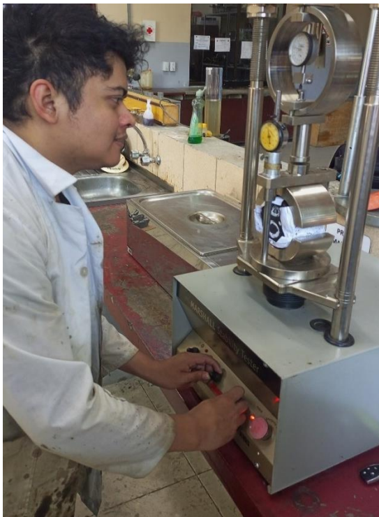
Proceso lectura y ruptura de briqueta mediante equipo Marshall.
