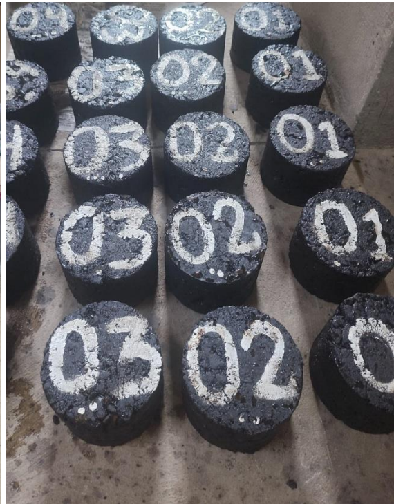
Proceso lectura y ruptura de briqueta mediante equipo Marshall.
