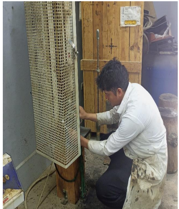
Proceso de compactación de la briqueta de ensayo.
