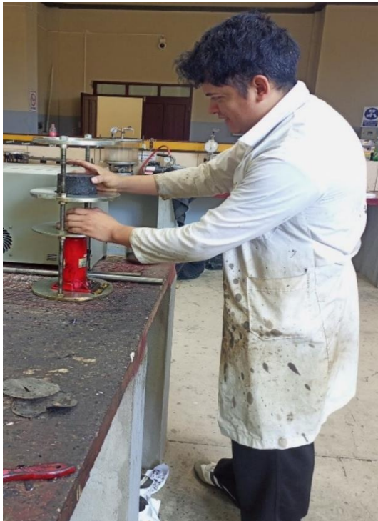
Proceso lectura y ruptura de briqueta mediante equipo Marshall.
