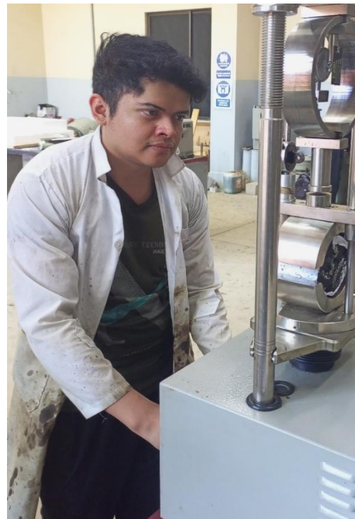
Proceso lectura y ruptura de briqueta mediante equipo Marshall.
