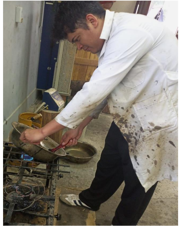
Mezcla del agregado con el cemento asfáltico
