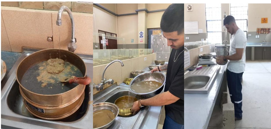
Figura 3.7. Proceso del lavado y tamizado de suelo
