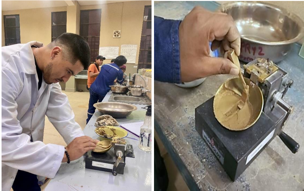
Figura 3.8. Determinación de limite liquido Equipo Casagrande
