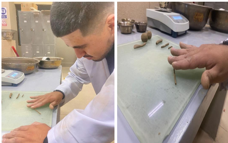
Figura 3.9. Determinación Limite Plástico
