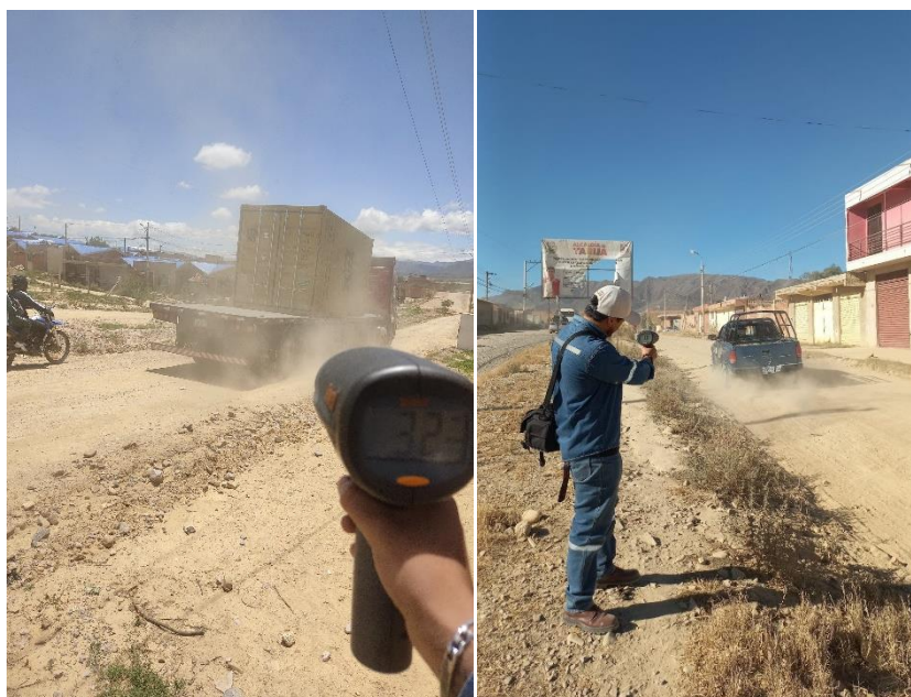
Figura 3.11. Aforo de velocidad con pistola radar
