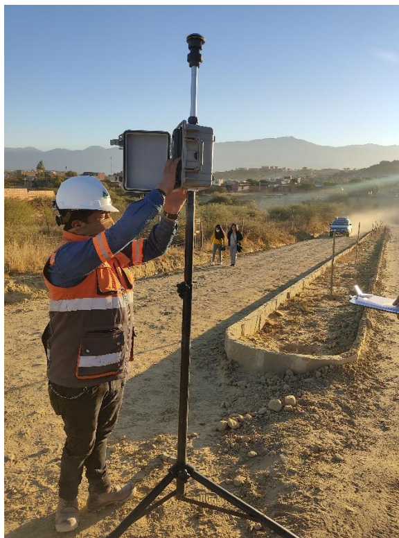
Figura 3.13. Instalación del MiniVol Tas
