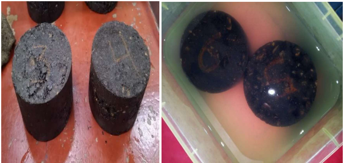
Figura 4.4. pérdida de material y material ligante en días de saturación.
