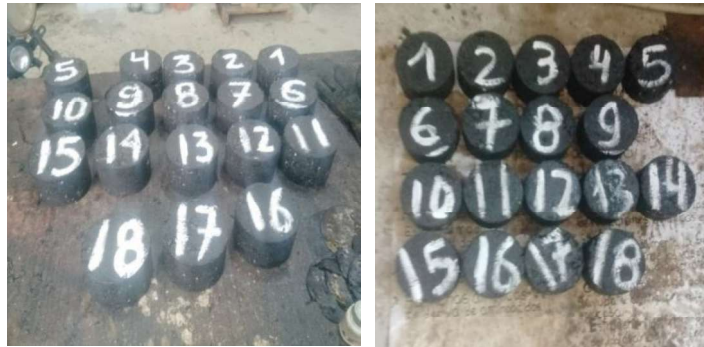
Figura 3.9. Reposo de briquetas según su porcentaje de cemento asfáltico.
