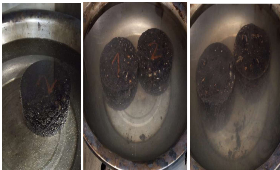
Figura 4.1. perdida de material y material ligante en días de saturación.
