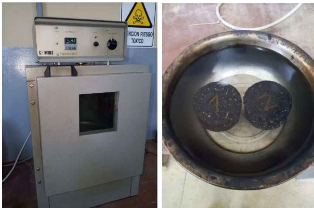
Figura 3.13. saturando briquetas de 42°C.
