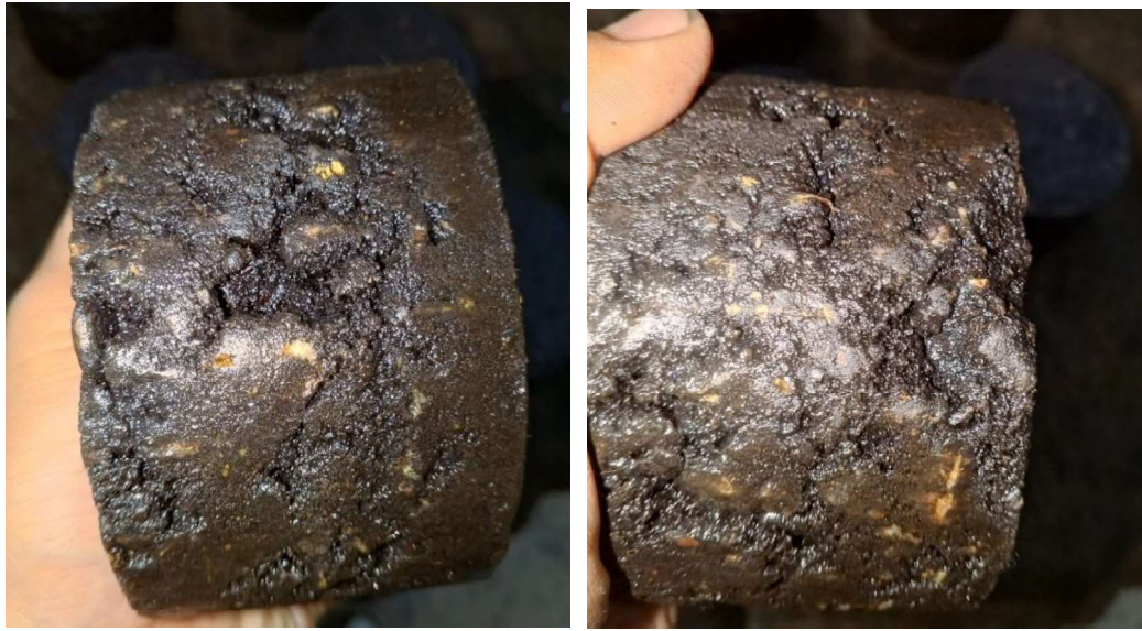
Figura 4.2. deformaciones y pérdida de material.
