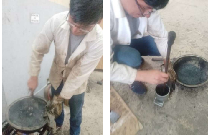
Figura 3.6. Mezclado del agregado con cemento asfáltico y colocando al molde.
