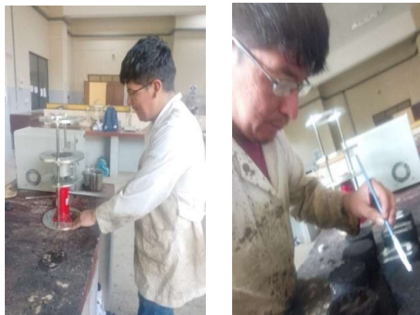
Figura 3.8. Proceso de desmolde de la briqueta y marcando briquetas.
