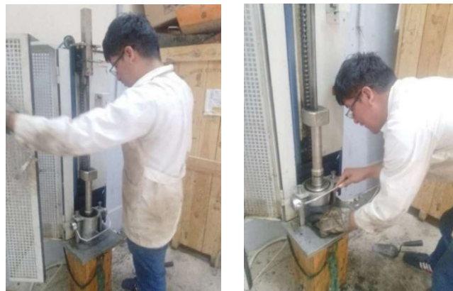
Figura 3.7. Compactación de la briqueta con el martillo Marshall mecánico.
