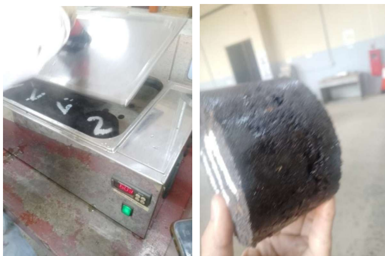
Figura 3.11. Determinación del peso seco y sumergido en agua.
