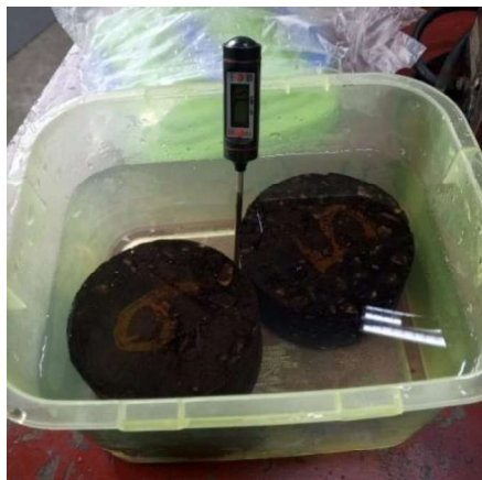
Figura 3.15. saturando briquetas de 2°C.
