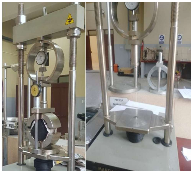
Figura 2.1. Máquina del ensayo Marshall
