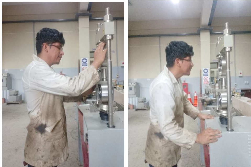
Figura 3.12. Colocación de biqueta al equipo Marshall y midiendo.
