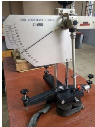
Figura 3.17. utilizando el péndulo.
