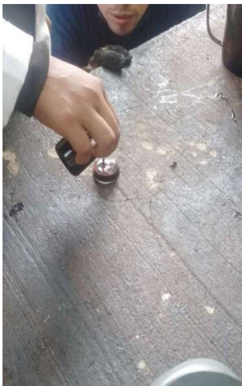
Llenando el frasco con el cemento asfáltico.
