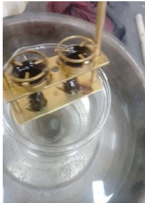
Cemento asfáltico en su punto de ablandamiento.
