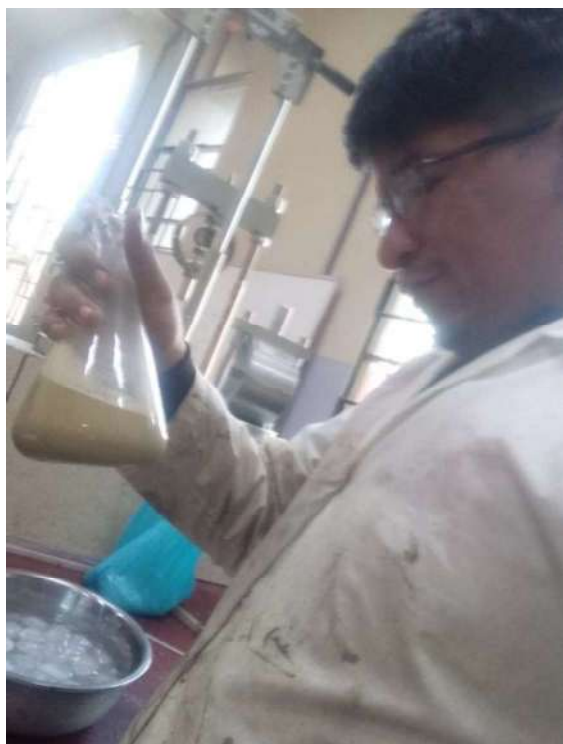
Vertido del filler al frasco volumétrico.
