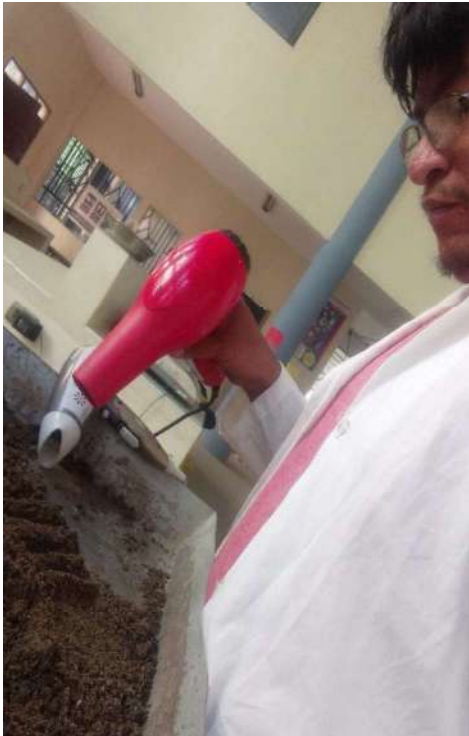
Secado uniforme del material fino.
