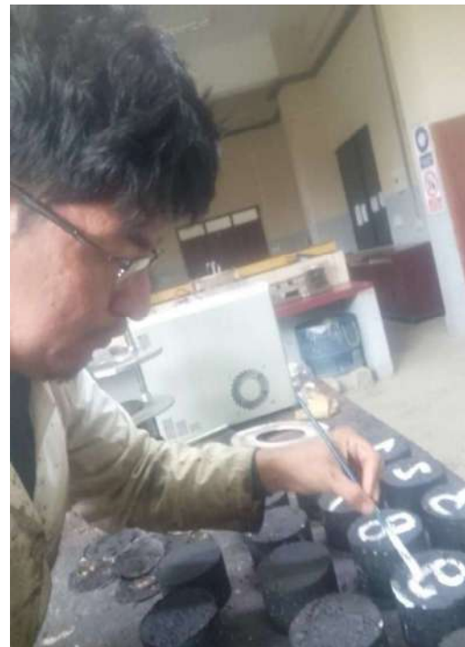
Marcando las briquetas de ensayo para identificarlas.
