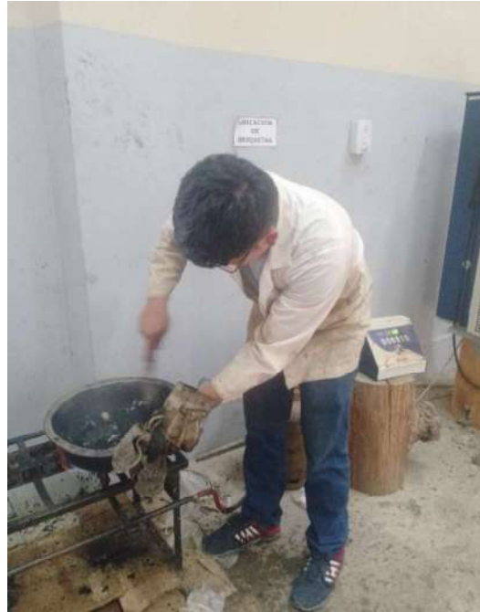
Mezcla del agregado con el cemento asfáltico.
