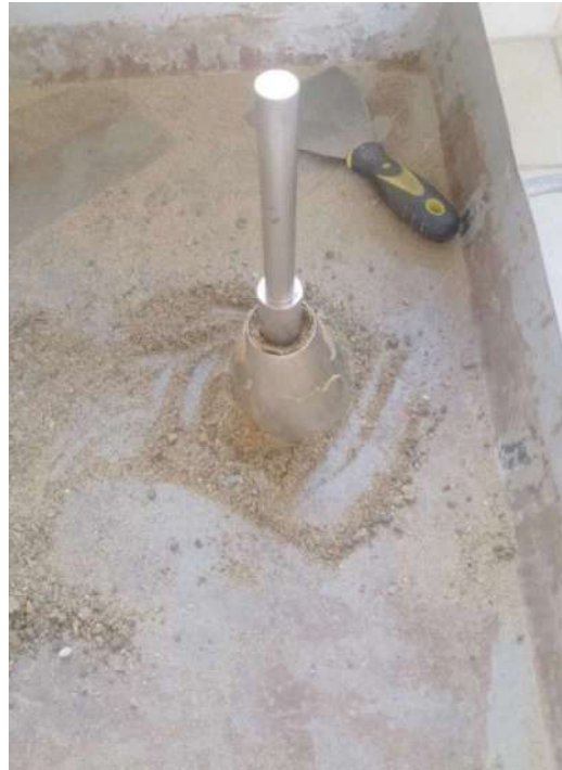
Prueba con el molde cónico.
