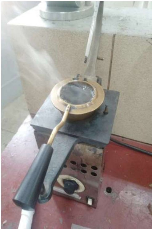
Aplicación de fuego al cemento asfáltico.
