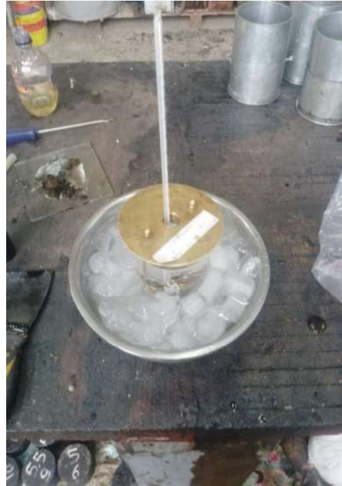
Disminución de temperatura de la muestra con hielo
