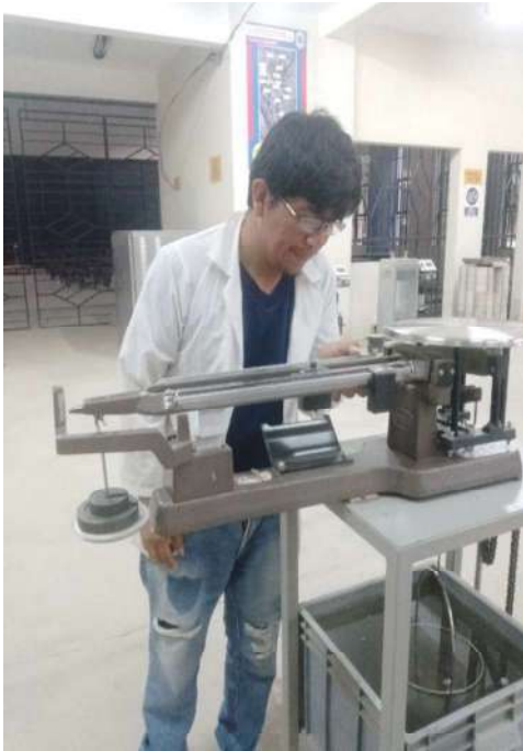
Pesaje del agregado sumergido en agua mediante una balanza hidrostática.
