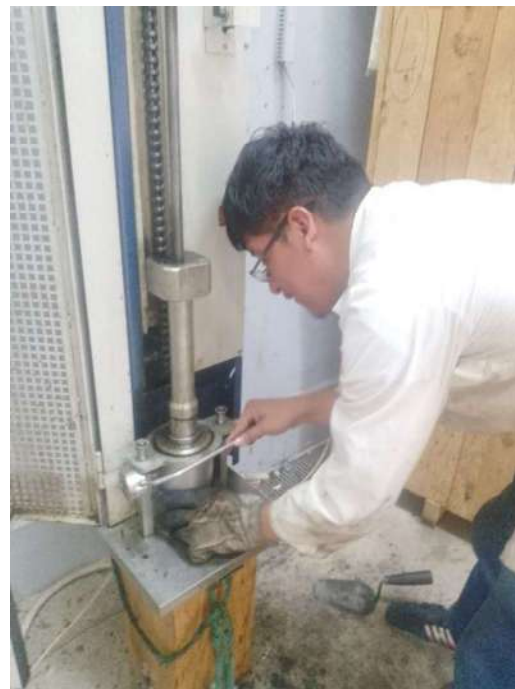
Proceso de compactación de la briqueta de ensayo.
