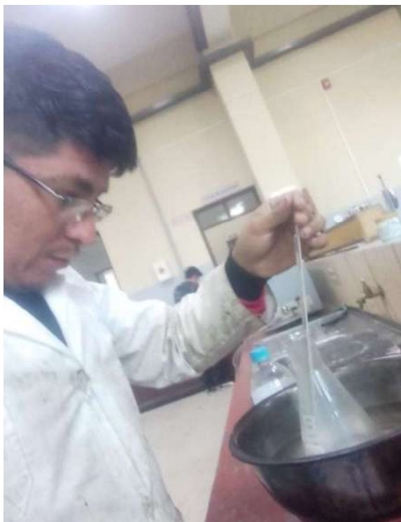
Calibración del frasco volumétrico.
