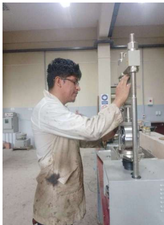
Proceso de ruptura de briqueta mediante equipo Marshall.
