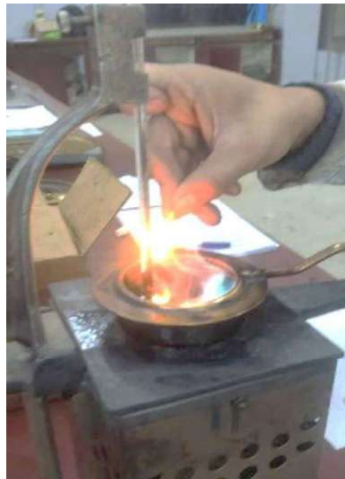
Cemento asfáltico en su punto de inflamación.
