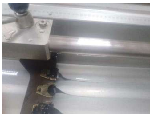
Proceso de estiramiento de la briqueta mediante el ductilímetro a 5 cm/minuto.
