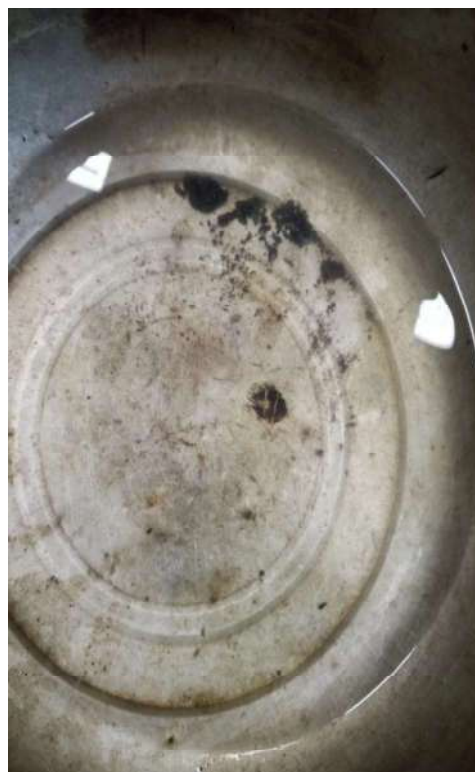
Viendo la perdida de material de la briqueta que quedo en la bandeja.
