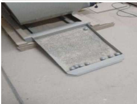
Vaciado del agregado y las esferas a la máquina de los Ángeles.
