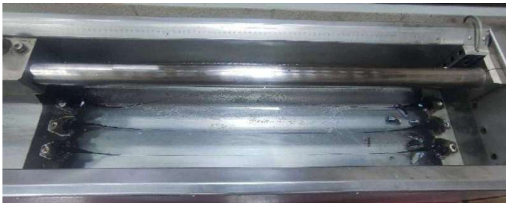
Proceso de estiramiento de la briqueta mediante el ductilímetro a 5 cm/minuto.
