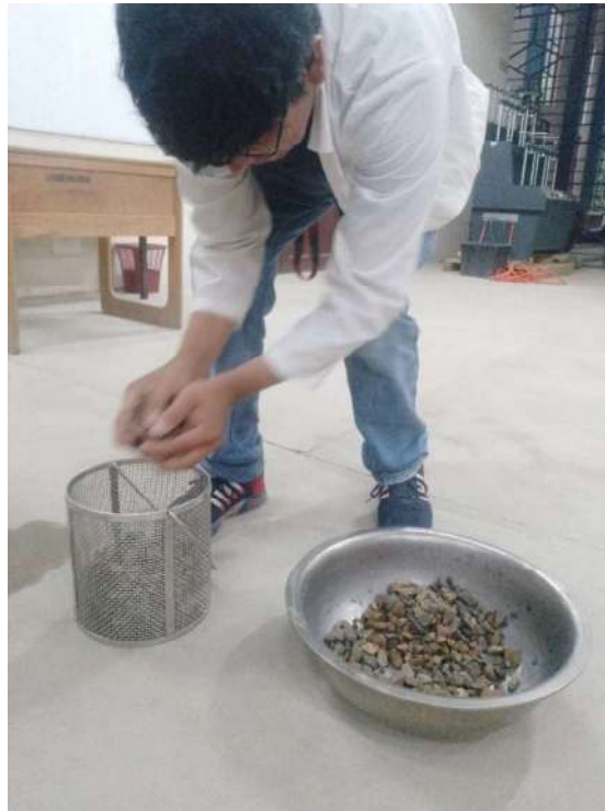
Vaciado del agregado en el canastillo.
