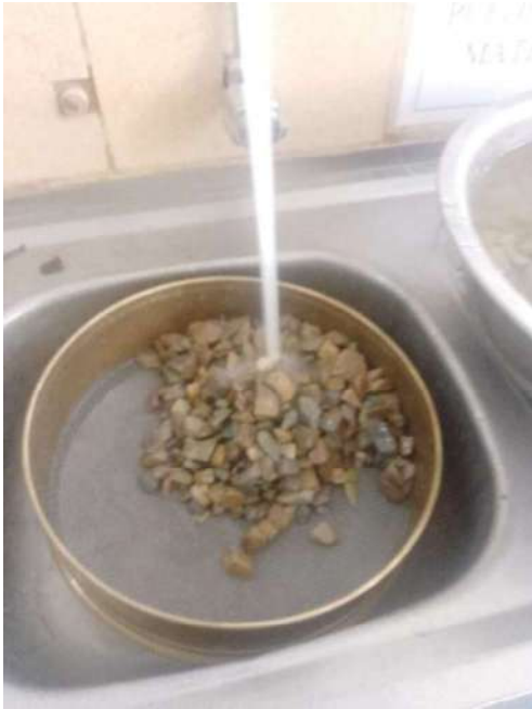
Lavar el agregado para sacar impurezas.
