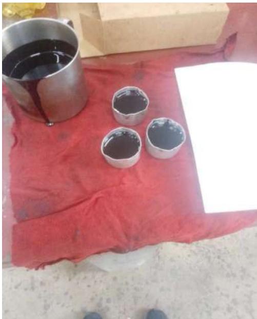
Vaciado del cemento asfáltico a las taras de ensayo.
