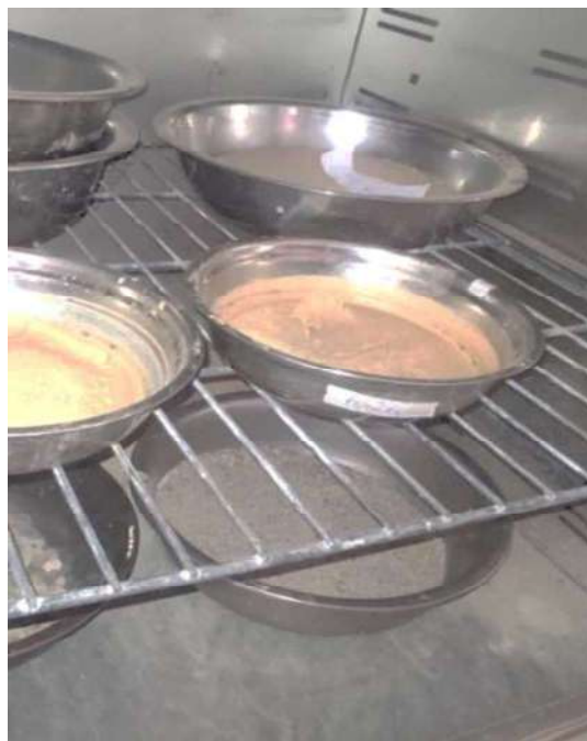
Material secando en el horno a durante 24 horas a 110 °C.
