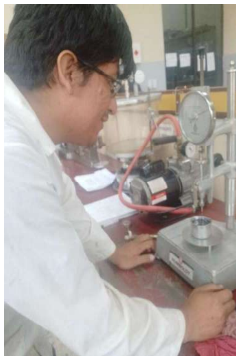
Realizando el ensayo de penetración al cemento asfáltico.
