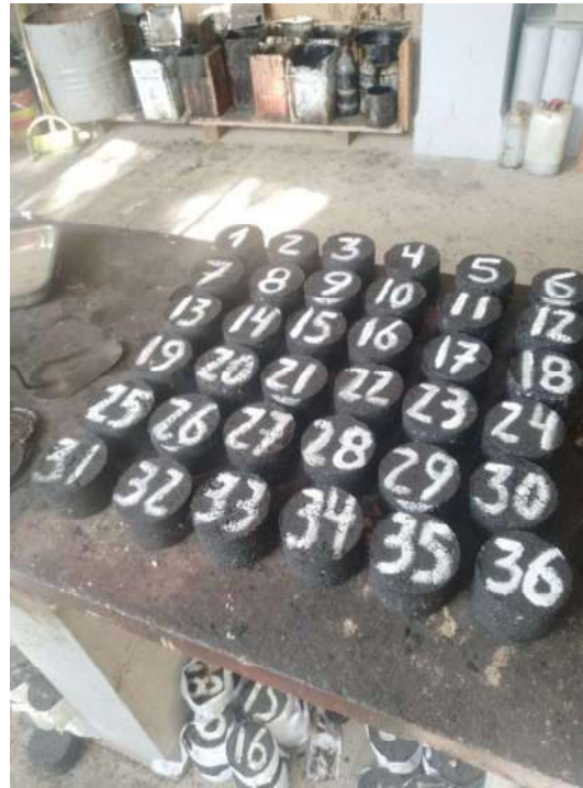
Briquetas de ensayo después de su elaboración.
