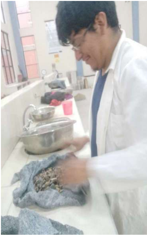
Secado del agregado con paños.
