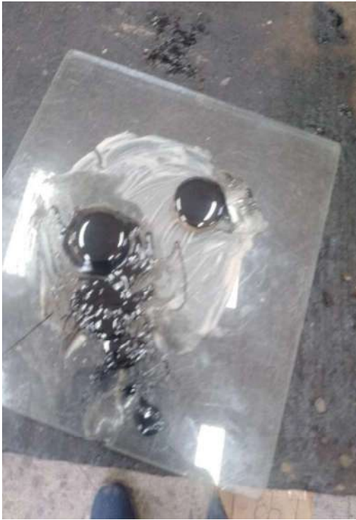
Llenado de cemento asfáltico a los anillos.
