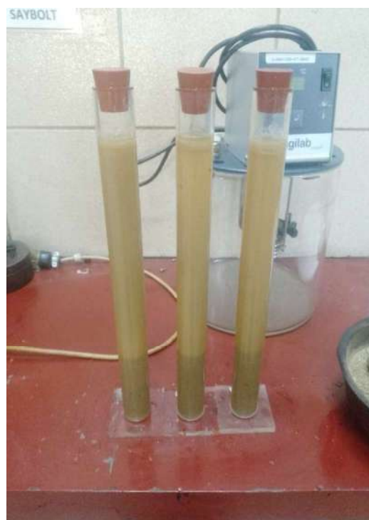
Muestra de ensayo sedimentada
