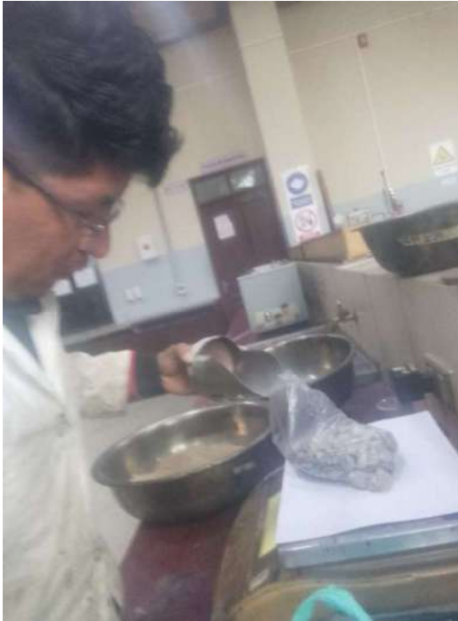
Pesaje del agregado según dosificación.
