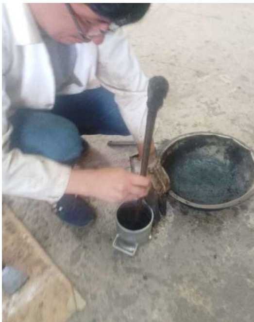
vaciando la mezcla asfáltica al molde en tres capas.
