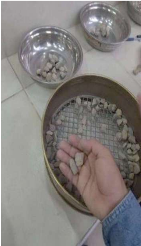
Selección de partículas fracturadas en un 25% o más producidas por medios mecánicos.
