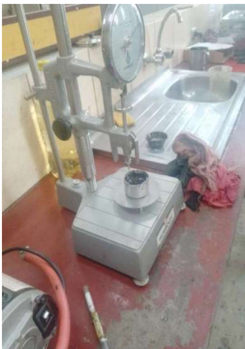
Equipo de penetración con una muestra para realizar el ensayo.
