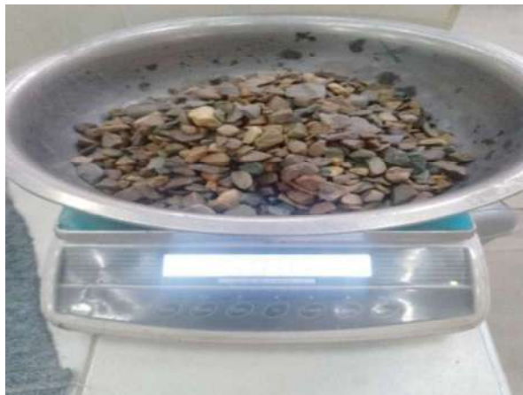
Proceso de pesaje de las partículas fracturas y no fracturadas.
