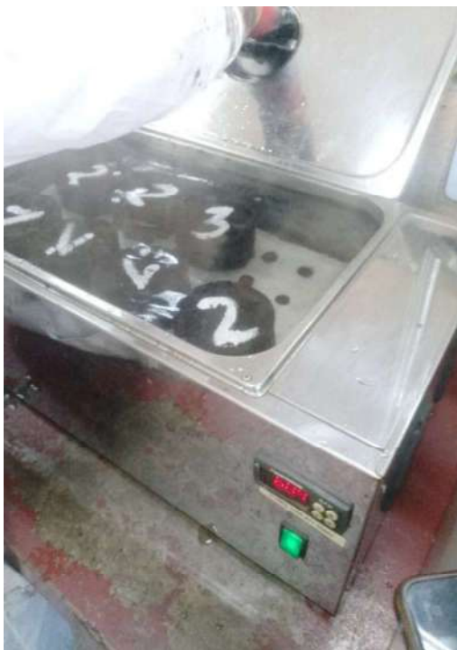
Briquetas sumergidas en agua para baño María.
