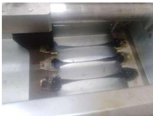
Proceso de estiramiento de la briqueta mediante el ductilímetro a 5 cm/minuto.
