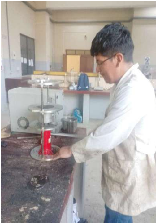
Desmolde de la briqueta de ensayo.
