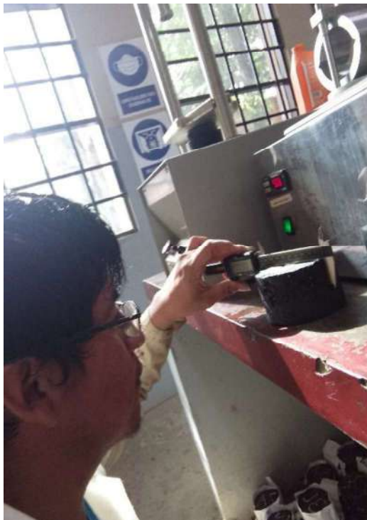
Medición del espesor de la briqueta de ensayo.
