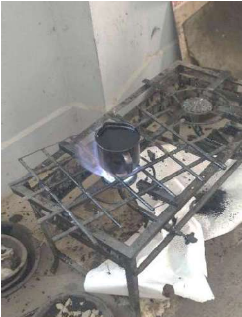
Calentado del cemento asfáltico.
