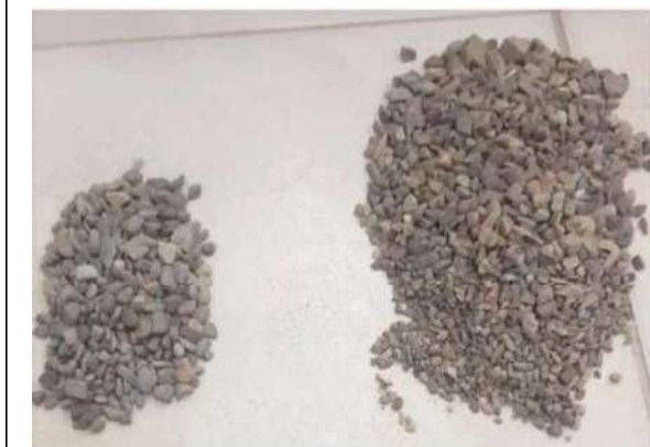
Partículas separadas en dos grupos: fracturadas y no fracturadas.
