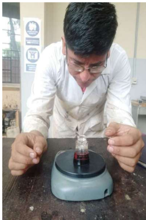
Determinación del peso de vaso + agua destilada + cemento asfáltico.
