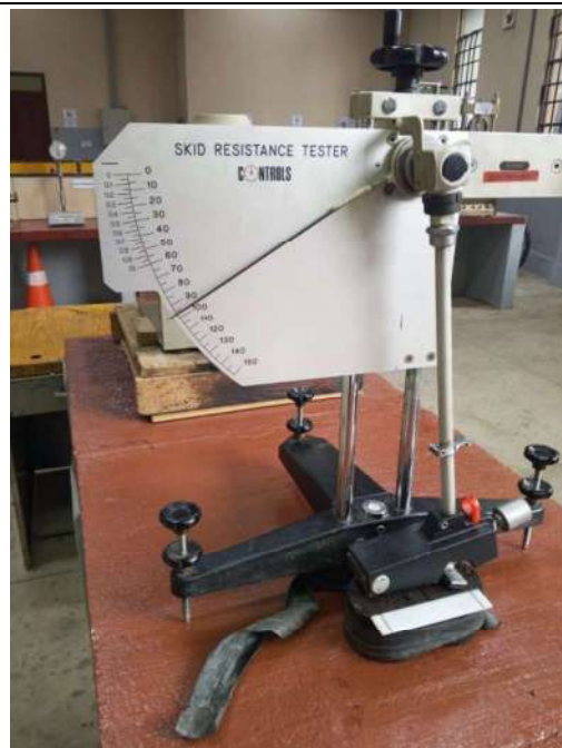
Midiendo el área de rozamiento con la regla del péndulo.
