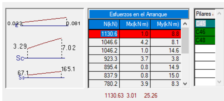
Figura 3.23. Esfuerzos en el arranque N, Mx, My (fuente: CYPECAD 2017)
