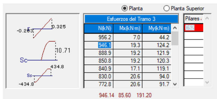
Figura 4.9. Esfuerzos de la columna C52 (fuente: CYPECAD 2017)
