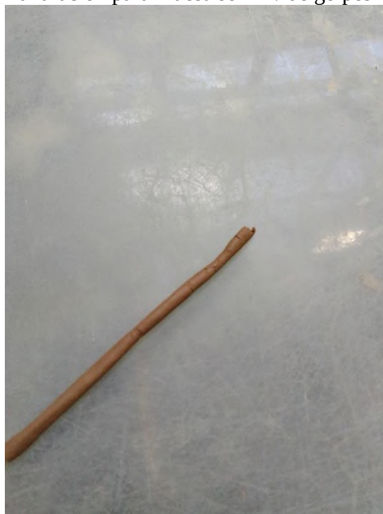
Aplicación de Ensayo del L.P.
