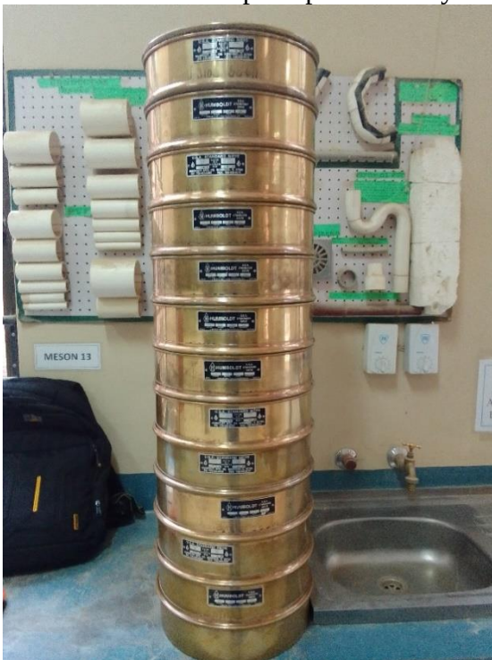
Juego de tamices usado según ASTM
