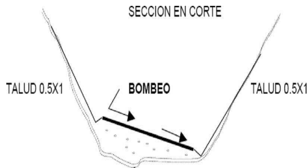
Figura 6 Bombeo en curva
