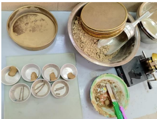
Imagen 3.7 Muestras pesadas y listas para horno
