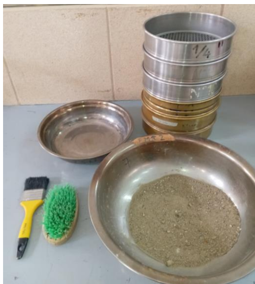
Imagen 3.6 Muestra lavada y secada para tamizar
