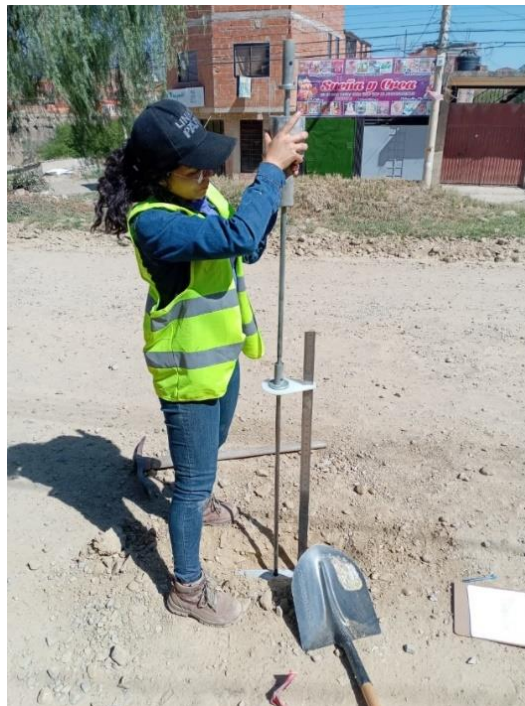
Imagen 3.9 Ejecución del ensayo DCP
