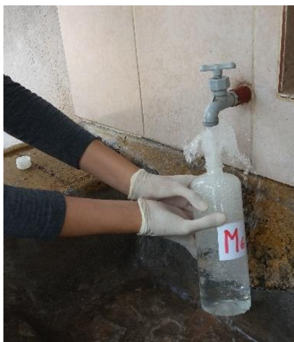
IMAGEN N° 24 PROCEDIMIENTO PARA LA TOMA DE MUESTRAS EN LAS DOS CASAS MÁS ALEJADAS DEL SISTEMA DE CLORACIÓN
