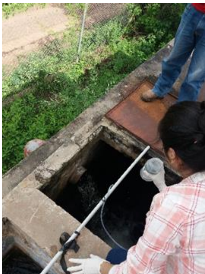
IMAGEN N° 20 PROCEDIMIENTO PARA LA TOMA DE MUESTRAS EN EL P1 TANQUE CLORADOR.
