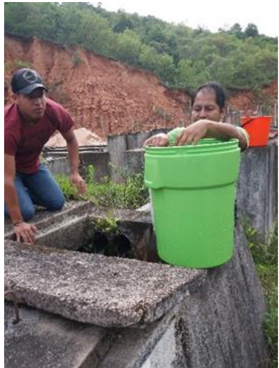
IMAGEN N° 9 AFORO DEL CUDAL Q_2 : Tubería
