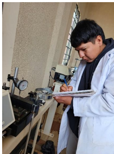
Figura 3.8: Lecturación del ensayo de corte directo
