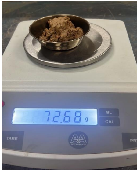
Figura 3.5: Determinación de contenido de humedad.
