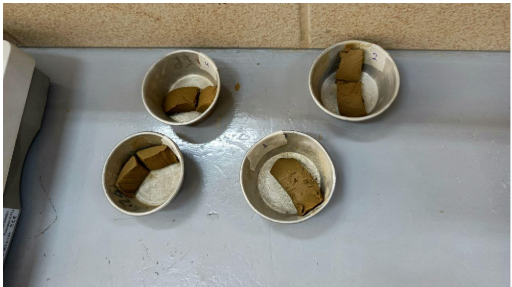
Figura 3.10: Ensayo límite líquido
