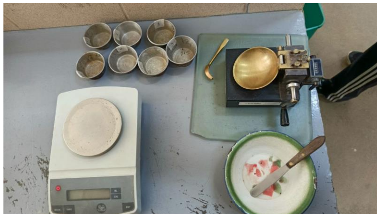
Figura 3.9: Materiales para la determinación de los límites de consistencia
