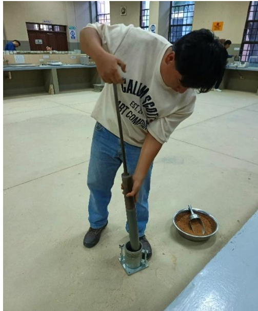
Figura 3.1: Ensayo de compactación
