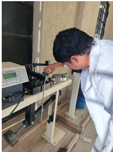
Figura 3.6: Verificación del equipo de corte directo.
