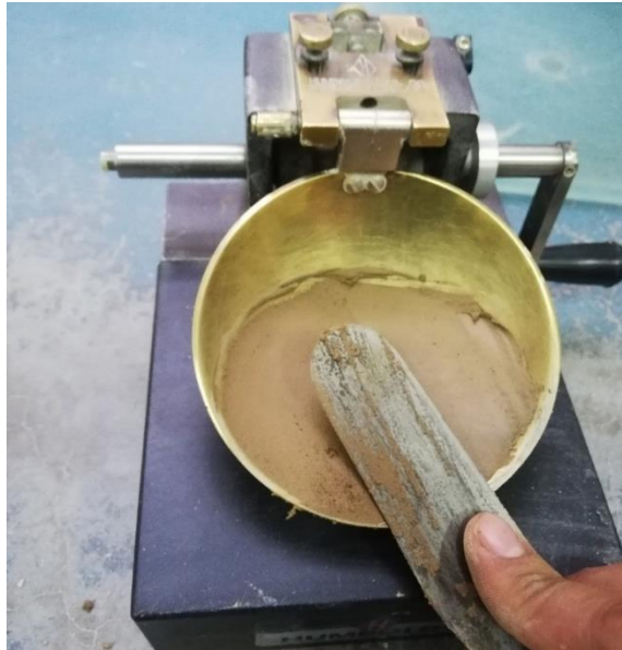
Figura 2.4: Determinación del límite líquido
