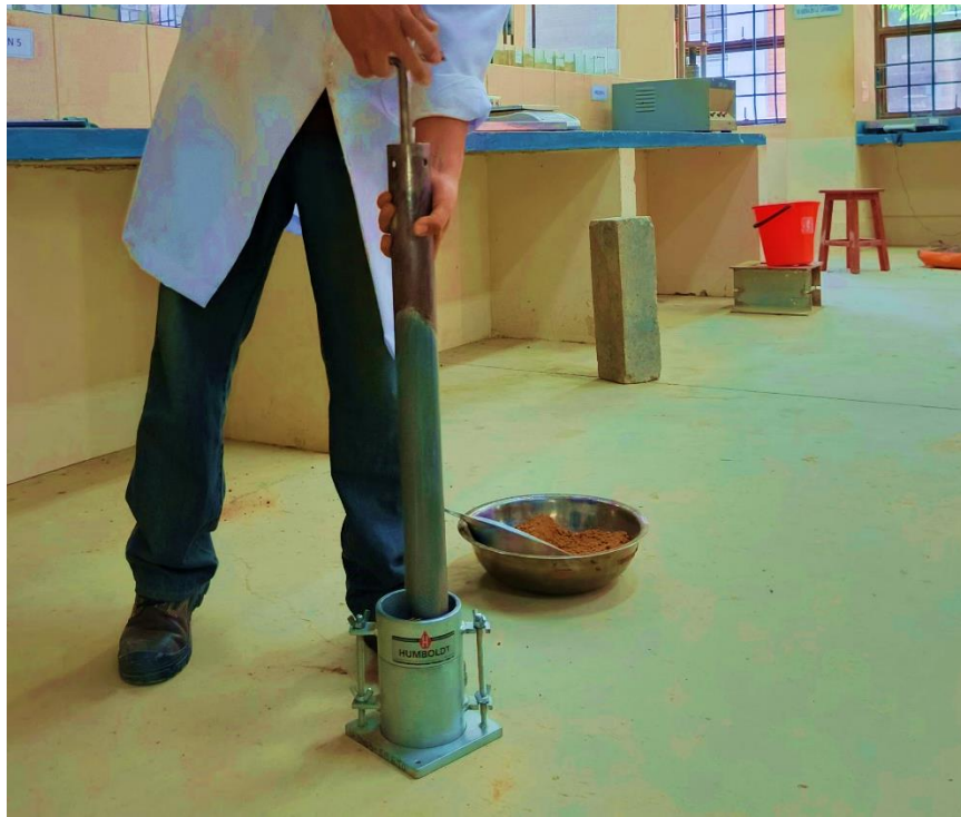
Figura 2.7: Compactación del suelo
