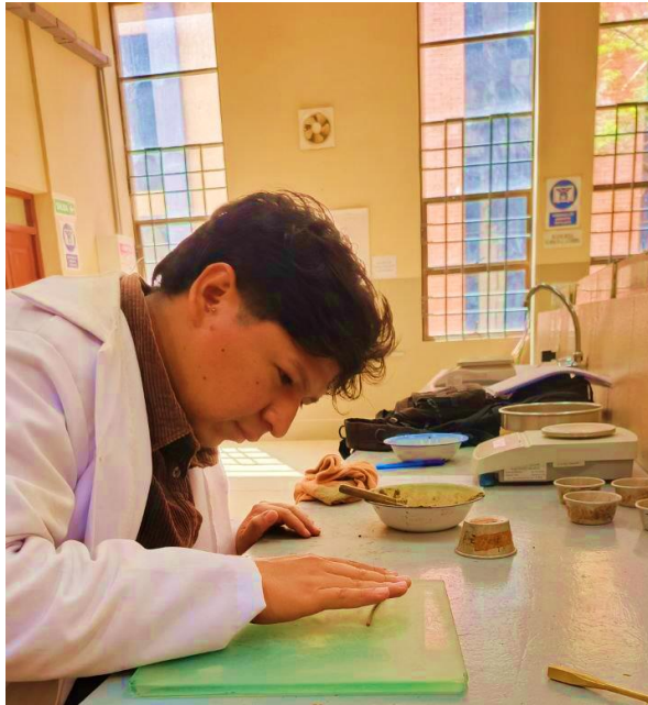
Figura 3.11: Ensayo límite plástico
