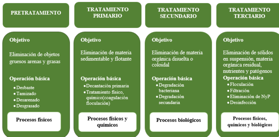
Figura 4. Tratamiento de aguas residuales
