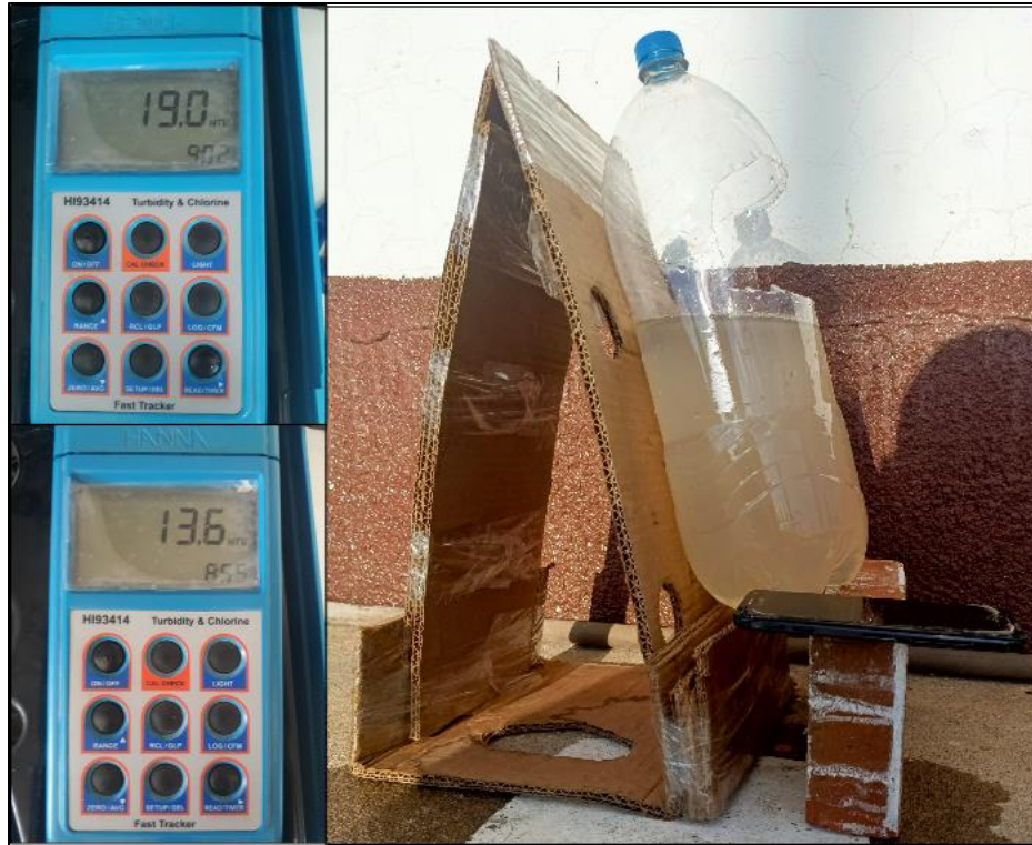
Figura 37. Ensayo empírico de sedimentación con soportes a 45° y 60° en el laboratorio de la planta de Tabladita.
