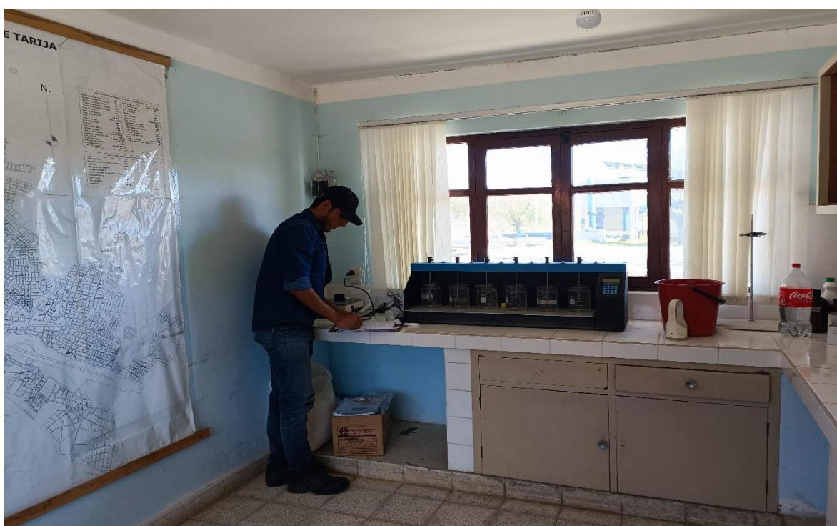
Figura B.8 Realización de la prueba de Jarras en el laboratorio de la planta para la selección de la dosis óptima de coagulante.
