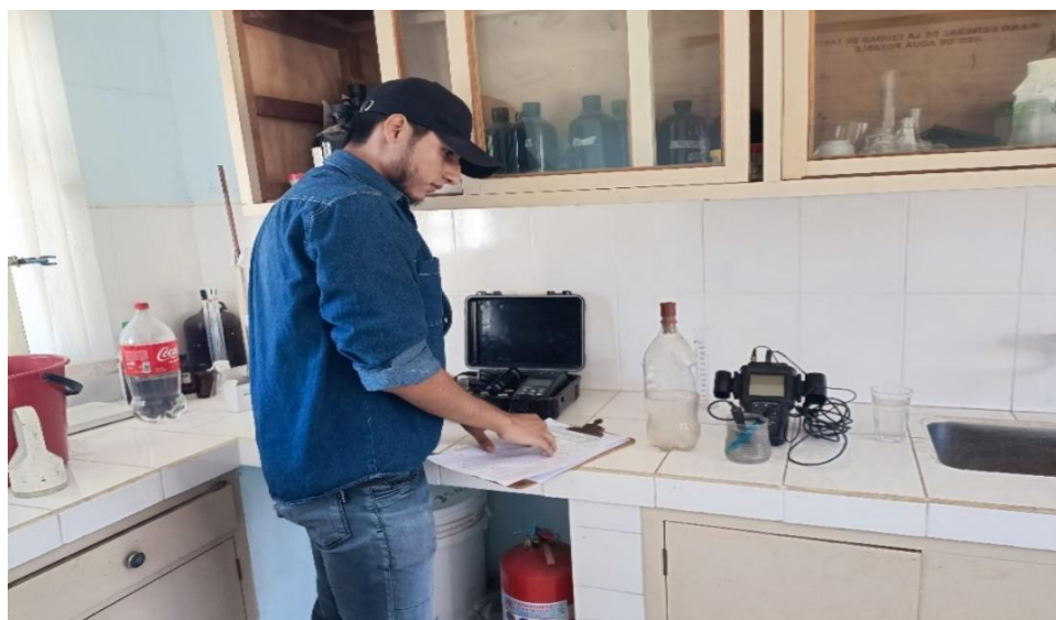
Figura B.9 Exposición de los equipos portátiles utilizados en el laboratorio de la planta para la medición de parámetros (Turbiedad y pH).
