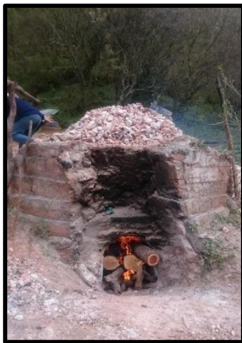
Calcinación del Sulfato de Calcio di Hidratado, Sin Equipo Ventilador (Cantón San Diego, productor Sr. Teodoro Donaire).
