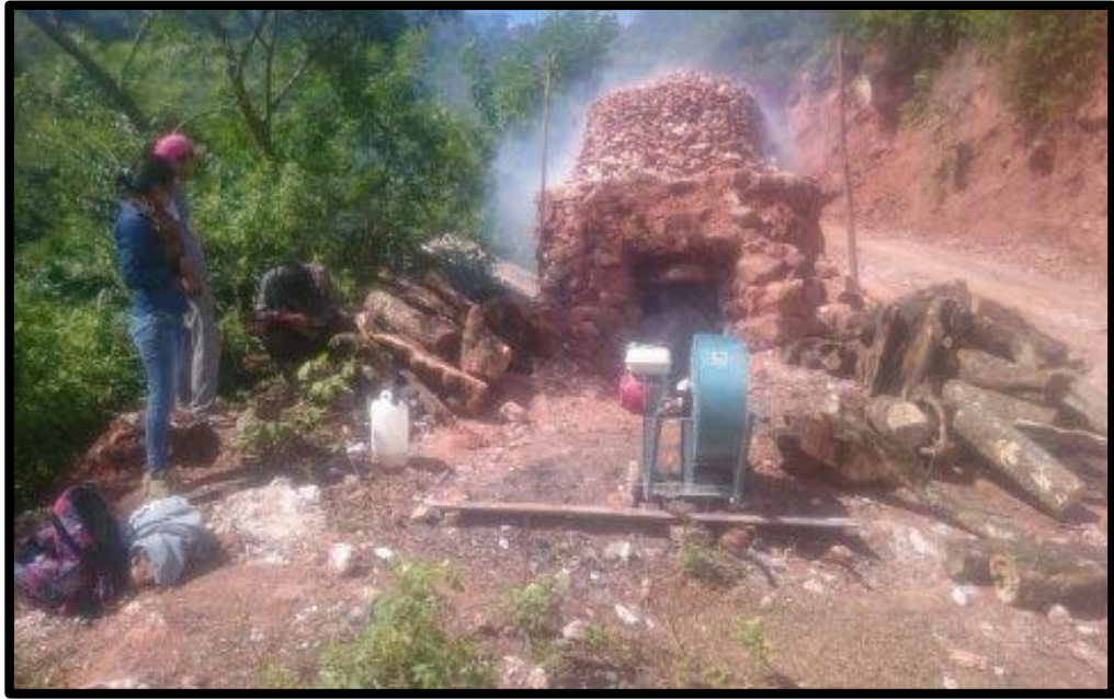
Calcinación del Sulfato de Calcio di Hidratado (Cantón, productor Sr. Mario Núñez).
