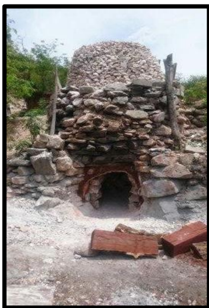
Horno Tipo Volcán Fuego Directo (Cantón Huayco, productor Sr. Calixto Bautista).
