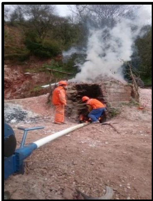
Calcinación del Sulfato de Calcio di Hidratado (Cantón San Diego, productor Sr. Teodoro Donaire).
