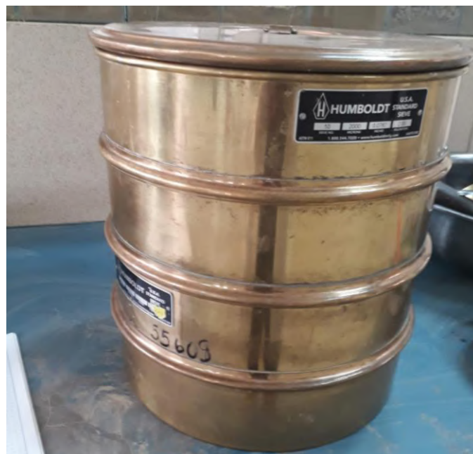
Imagen 11. Realización de granulometria
