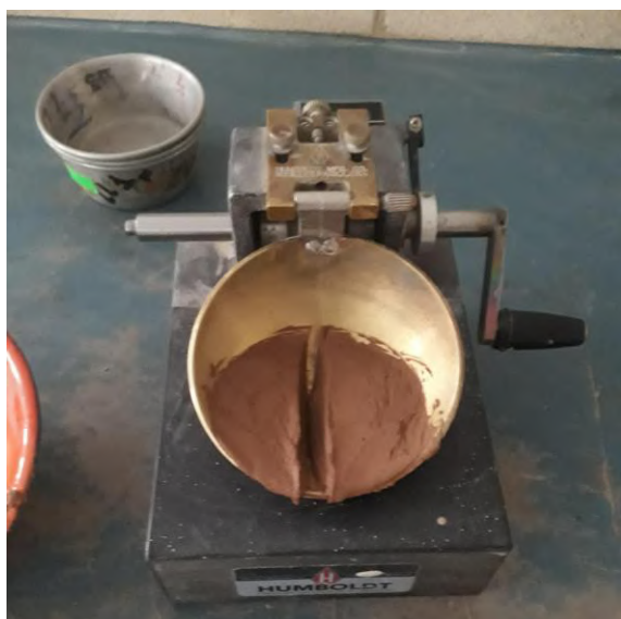
Imagen 15. Pasta dividida en 2 para posteriormente dar la vuelta la manija y realizar el conteo respectivo.
