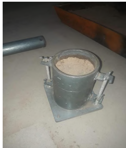
Imagen 7. Compactación de la muestra
