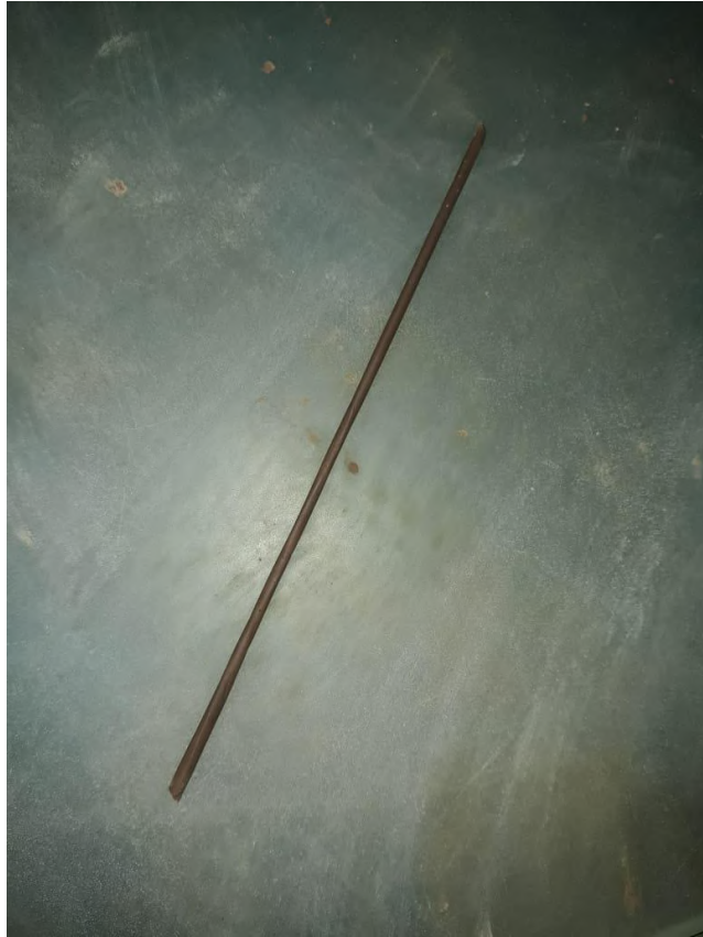
Imagen 16. Realización del rollito con la palma de la mano sobre una superficie plana hasta formar un cilindro como se muestra en la imagen .
