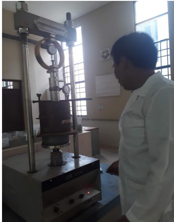
Imagen 10. Ensayando la muestra para obtener los datos y obtener los resultados de CBR
