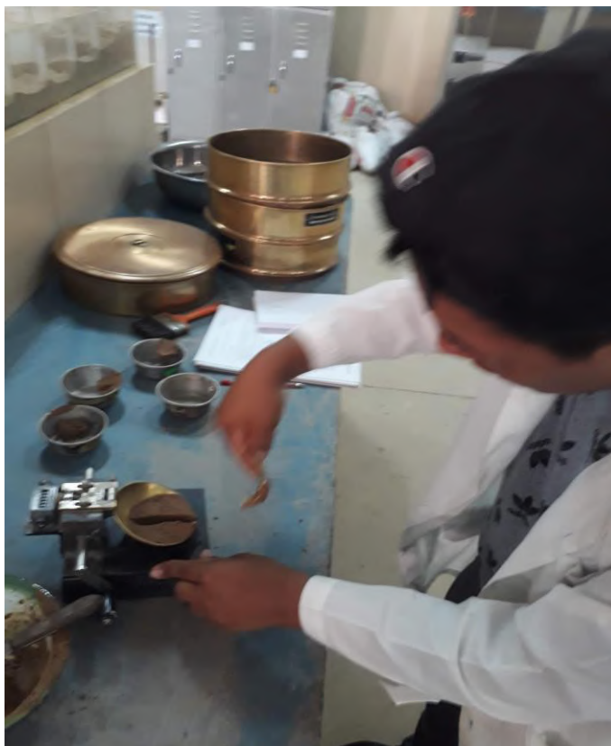
Imagen 14. Realizando el corte en 2 de la pasta en la copa de casa grande
