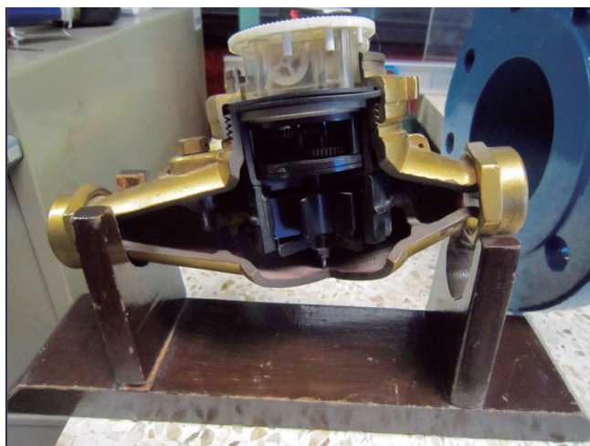
Figura 6 : Vista interior del micromedidor. Fuente: Comisión Nacional del Agua, (2015).
