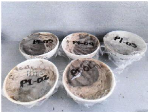
Preparación de suelos para determinación de Límites Atterberg, verificación de suelos no cohesivos
