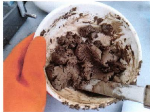
Preparación de suelos para determinación de Límites Atterberg, verificación de suelos no cohesivos
