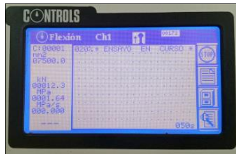
Resultados de resistencia a tracción a 28 días para cada dosificación de fibra Con 0.00 de Fibra de vidrio TOL
