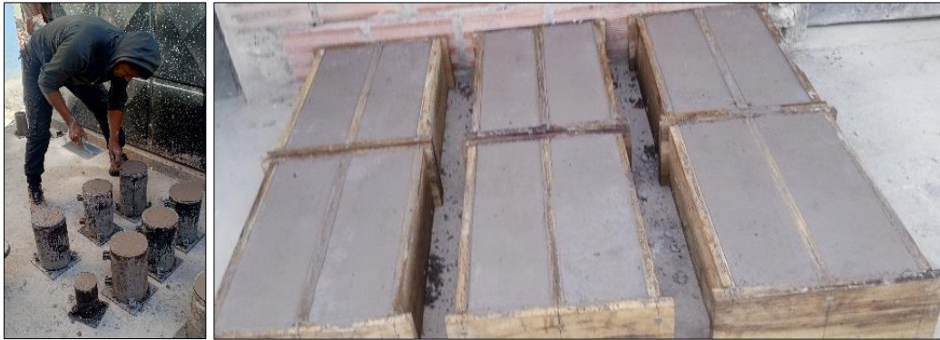
Probetas y vigas ya terminados.
