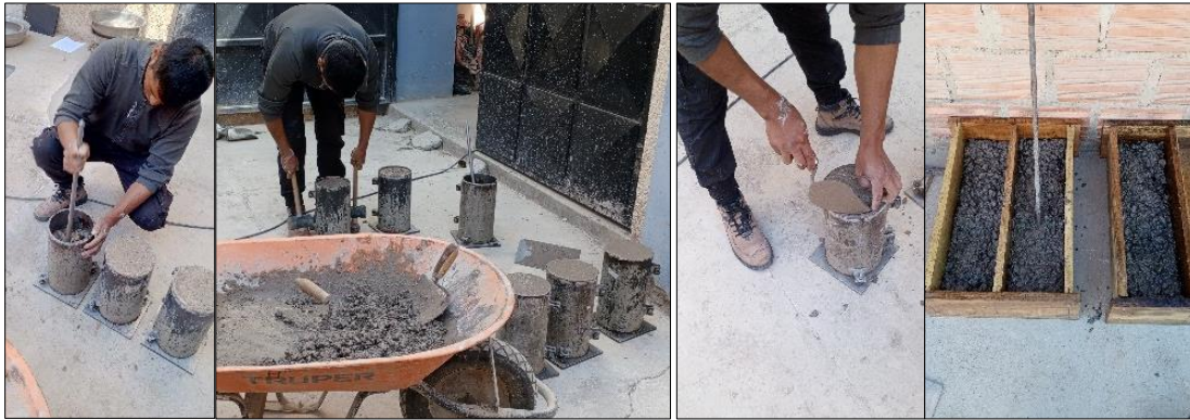
Colocado de la mezcla en las probetas, vigas.
