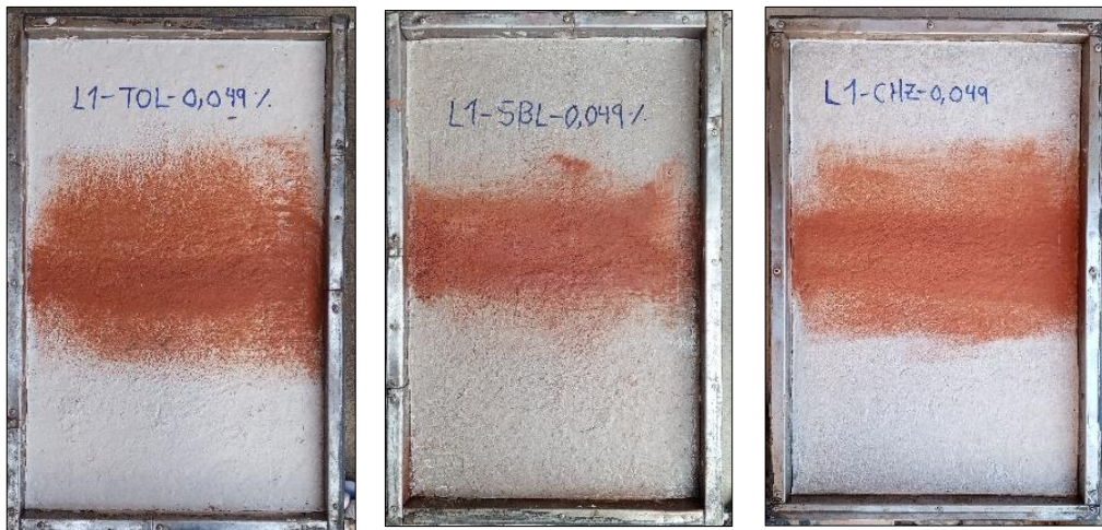
Paneles con 1.30 kg/m 3 de fibra
