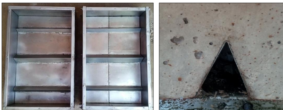
Moldes de acero inoxidable con restricciones internas,
