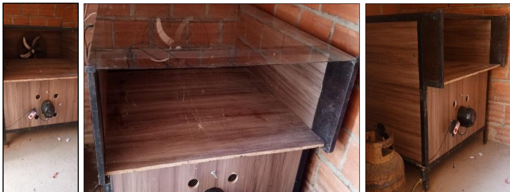
Fabricación de la máquina de curado acelerado.
