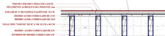
CORTE DE LOSA ENCASETONADA ESC. 1:10
