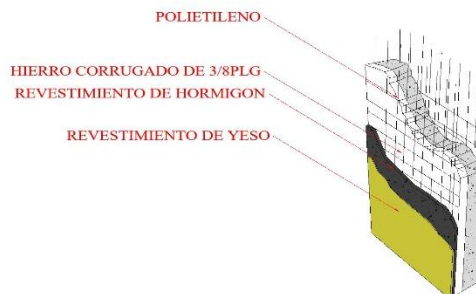
DETALLE DEL PANEL VERTICAL ESC:1:20
