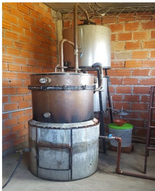
Figura 1- 1.-Alambique utilizado en la industria artesanal "CAÑA REAL"
